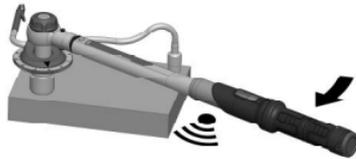
Stellen Sie nun das Drehmoment-Schraubwerkzeug auf sein max. zulässiges Drehmoment ein. Stellen Sie die Gradscheibe auf den gewünschten Winkel ein.
