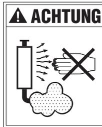
Auspuff, andere Motorteile, Schmieröl und Kühlflüssigkeit können im Betrieb sehr heiß werden.
