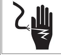
Die Zündkreise von Benzinmotoren führen hohe Spannungen. Außerdem können im niederohmigen Batteriestromkreis hohe Ströme fließen.
