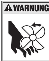
Am Motor sind Ventilator, Keil- oder Zahnriemen und andere rotierende Teile.
