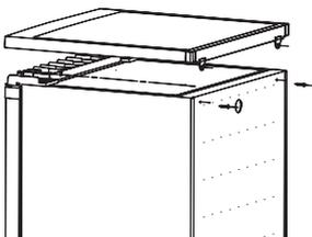
2. Entfernen Sie die vier Schrauben, wie auf der unteren Abbildung dargestellt. Entfernen Sie die Achse des oberen Scharniers und bewahren Sie sie in der
