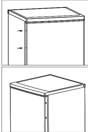
2. Montieren Sie den Türgriff so, dass die Bohrungen des Türgriffs mit den Bohrungen der Tür übereinstimmen. Schrauben Sie danach den Türgriff mit den beiden Schrauben fest, die Sie vorher aus der Tür entfernt haben.
