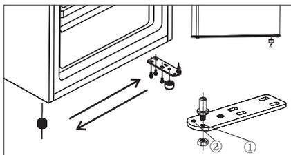
4. Montieren Sie die Tür in die neue Position und achten Sie darauf, dass die Achse des Scharniers in die Öffnung am unteren Teil des Rahmens ragt. Montieren Sie die Abdeckung, indem Sie die Achse des oberen Scharniers in die Bohrung oben an der Tür einsetzen und mit zwei Schrauben befestigen. Versetzen Sie noch die beiden Schrauben auf die andere Seite.
