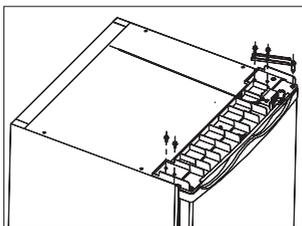
3. Heben Sie die Tür an und stellen Sie sie auf eine weiche Unterlage, damit sie nicht zerkratzt wird. Entfernen Sie die beiden verstellbaren Gerätefüße sowie den Träger des unteren Scharniers, indem Sie die Schrauben lösen. Versetzen Sie diese auf die andere Seite des Geräts.
