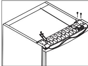
5. Legen Sie die Abdeckung auf den Gefrierteil. Schrauben Sie die beiden Schrauben an der Rückseite der oberen Abdeckung fest.
