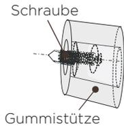
3. Richten Sie die Schraube mit der Bohrung in der Unterseite des Geräts aus. Schrauben Sie die Gummistütze mit einem Kreuzschlitzschraubendreher (nicht beigelegt) auf die Abdeckung der Unterseite des Geräts fest.
