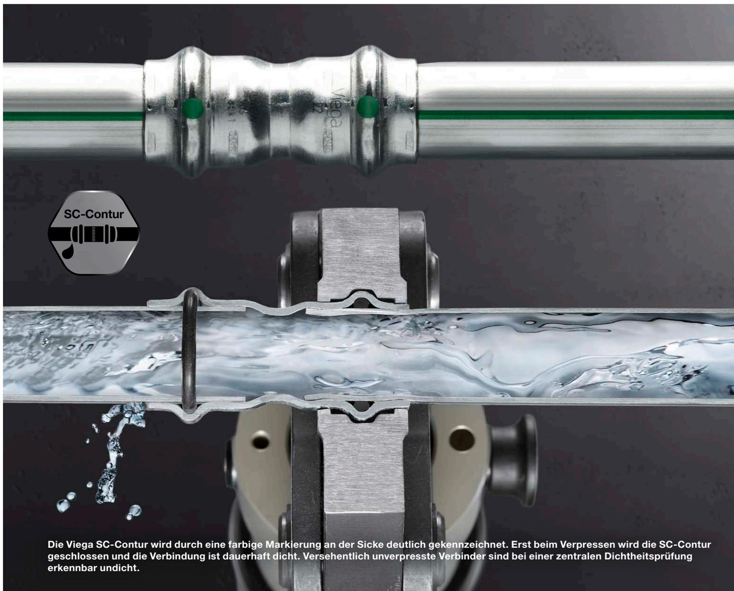
Die Viega SC-Contur wird durch eine farbige Markierung an der Sicke deutlich gekennzeichnet. Erst beim Verpressen wird die SC-Contur geschlossen und die Verbindung ist dauerhaft dicht. Versehentlich unverpresste Verbinder sind bei einer zentralen Dichtheitsprüfung erkennbar undicht.
