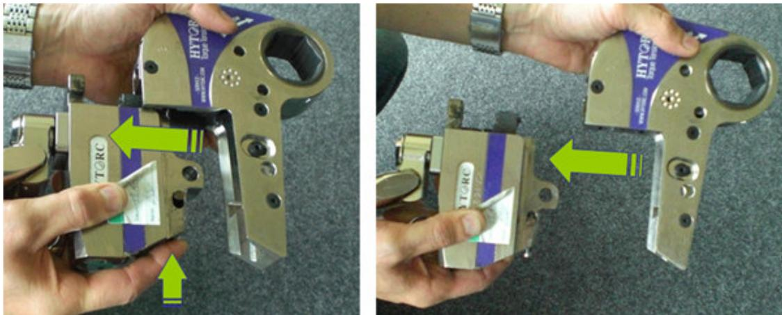
Zusammensetzen in umgekehrter Reihenfolge, der Entriegelungs-Knopf muss dabei nicht gedrückt werden. Vor dem nächsten Einsatz an die Hydraulik-Pumpe anschließen und einige Kontroll-Hübe bzw. Leerhübe durchführen. Dies dient dazu, den Kolbstangen-Haken des Hydraulik-Kopfes in die Kassette einzuhaken. Erst jetzt ist das Werkzeug korrekt zusammengesetzt und einsatzbereit.
