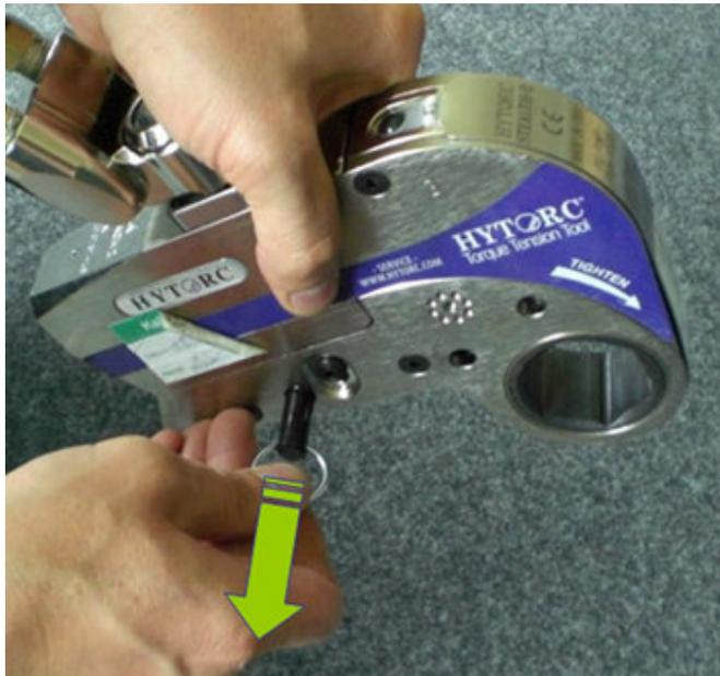
Den Entriegelungs-Knopf am hinteren Teil der Hydraulik-Einheit gedrückt halten und gleichzeitig die Hydraulik-Einheit des Werkzeuges nach oben heraus ziehen.
