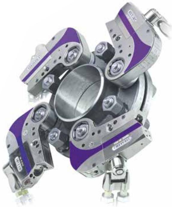
← Planparalleles, simultanes Verschrauben durch gleichzeitige Vorspannkrafteinleitung an mindestens vier Stellen und bei stets gleichen Drehwinkeln. Dadurch werden die Muttern drehmoment- und weggesteuert angezogen und gewährleisten eine gleichmäßige Belastung der Dichtung.
