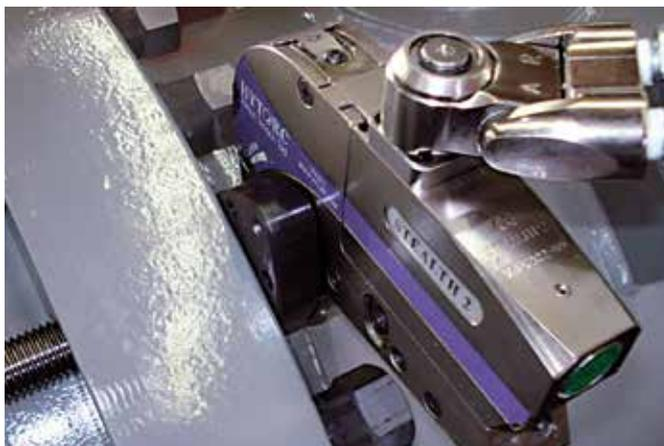
↑ STEALTH-2 mit DISC-Unterlegscheibe am Behälterdeckel
