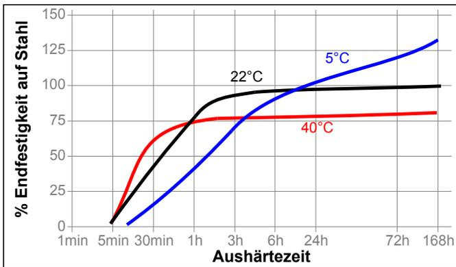
**Aushärtegeschwindigkeit in Abhängigkeit vom Aktivator**
