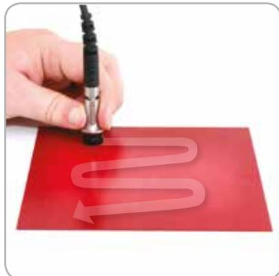
Wenn der Scanmodus\* gewählt ist, kann die Ultra/Scan-Sonde über die gesamte Oberfläche gezogen werden. Wenn die Sonde von der Oberfläche abgehoben wird, zeigt das Messgerät den durchschnittlichen, maximalen und minimalen Beschichtungsdickenwert an. Jede Gruppe von drei Messwerten (Durchschnitt, Maximum und Minimum) kann auf dem Verlaufsdiagramm angezeigt und im Speicher abgelegt werden.
