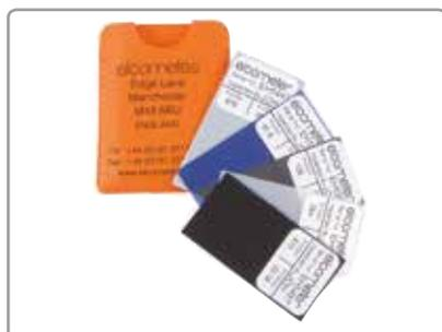
Die Elcometer 990 Kalibrierfolien sind ideal zur Nutzung im Labor, in der Produktion und auf der Baustelle. Kalibrierfolien bzw. Abstandsfolien sind die bequemste Art einen Schichtdickenstandard zu erzeugen auf dem Originaluntergrund oder auf der beschichteten Fläche oder Form. Dies ist die ideale Methode um die Kalibrierung des Schichtdickenmessgerätes anzupassen und die größtmögliche Genauigkeit zu erzielen.
