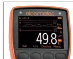
Das Verlaufsdiagramm zeigt jeden einzelnen Messwert an und gibt so Aufschluss über etwaige signifikante Trends
