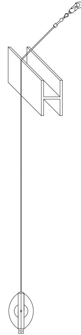
**FR :** Ne pas utiliser sur un angle de structure métallique en position horizontale
