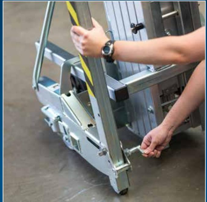
Öffnen und Fixieren der Vorderteile mittels Federriegel
