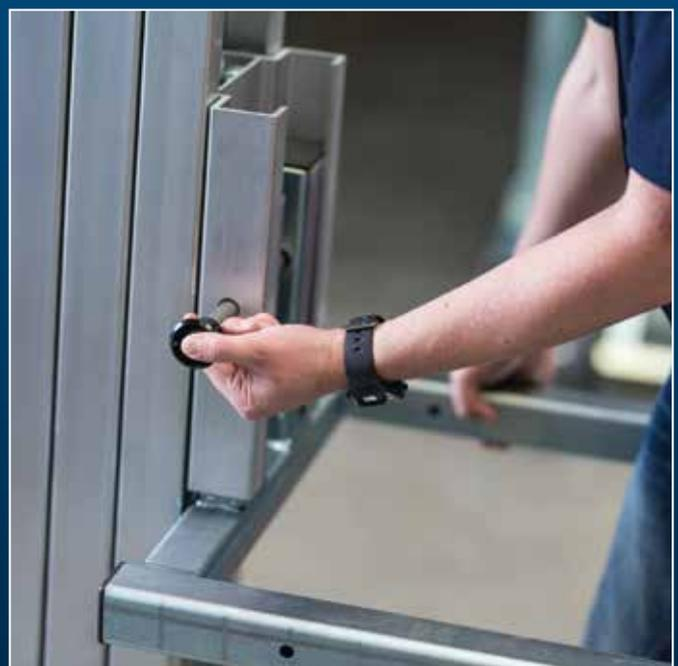
Montage und Fixierung der Lastgabel mittels Kugelsperbolzen
