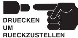
Den Knopf nicht gedrückt halten. Im Falle eines weiterhin bestehenden Fehlers kann der Thermoschutz nicht auslösen und damit kann das Aggregat, **beschädigt** werden.
