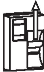
FI-Schutzschalter (D) einschalten, indem der Hebel nach oben geschoben wird. Der FI-Schutzschalter ist eine zusätzliche Schutzmaßnahme. Sobald im angeschlossenen Verbraucher ein Fehlerstrom, normalerweise 30 mA, über den Schutzleiter oder über Erde abfließt, spricht der FI-Schalter sehr schnell an.
