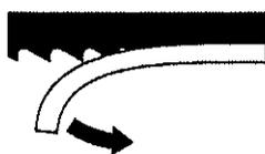
Entfernen Sie einen Kantenschutz des Sägebåndes erst nach einem Einlegen und einer Vorspannung des Sägebåndes. Sie verringern dadurch ein Verletzungsrisiko erheblich.
