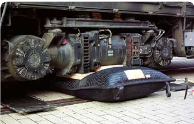
Anheben von Schienenfahrzeugen
