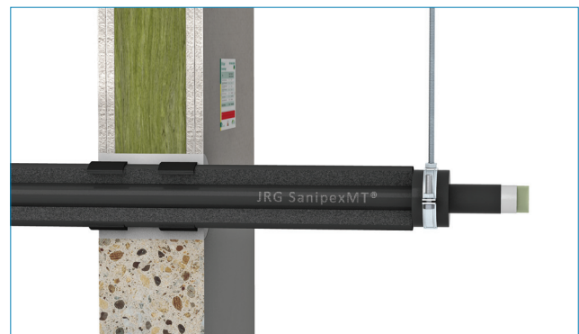
Abschottung in Wänden
