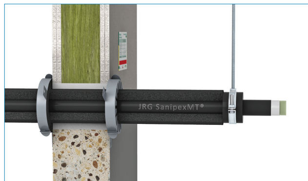
Abschottung in Wänden
