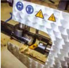
Die transportable Rohranfasmaschine dient zur Schweißnahtvorbereitung beim Schweißen von dickwandigen Rohren, Kesselrohren und Sammlern. Die Maschine ist durch das geringe Gewicht von nur einer Person bedienbar und eignet sich für Werkstatt und Baustelleneinsatz. Durch eine extrem kompakte Bauweise können Rohre auch in beengten Platzverhältnissen perfekt angefasst werden. Der Einsatz von TiN-
