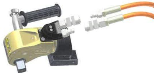
Sichern Sie die Hydraulikschläuche.
