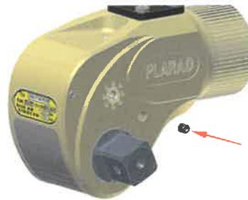
3. Schrauben am Abdeckblech entfernen und Abdeckblech abnehmen.
