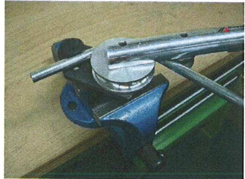
5) Zum Biegen wird nun der Biegehebel im Uhrzeigersinn um die Biegeform gezogen, bis das gewünschte Bogenmaß erreicht ist. Zur Entnahme des gebogenen Rohres wird der Biegehebel wieder aus dem Haltezapfen des Grundkörpers gezogen.
