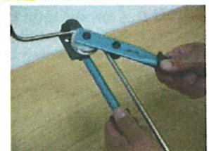
**Biegegerät Gr. 0 / bending tool size 0**
