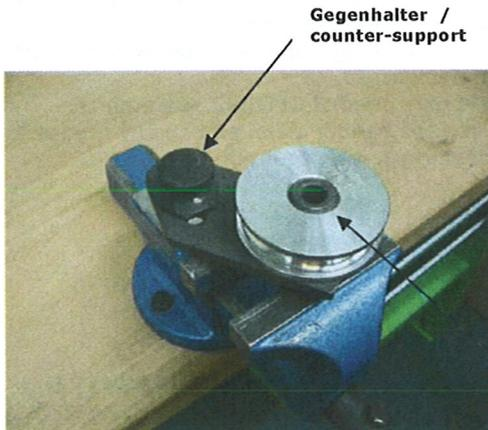
**2)** Der Gegenhalter wird in die, dem Außendurchmesser des zu biegenden Rohres entsprechende, Gewindebohrung des Grundkörpers eingeschraubt (Linksgewinde). Dementsprechend wird auch die Biegeform ausgewählt und auf den Haltezapfen des Grundkörpers gesteckt.
