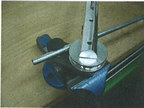
4) Nachdem das zu biegende Rohr zwischen Gegenhalter und Biegeform eingelegt wurde, kann der Biegehebel mit dem Drehbolzen in den Haltezapfen des Grundkörpers gesteckt werden.
