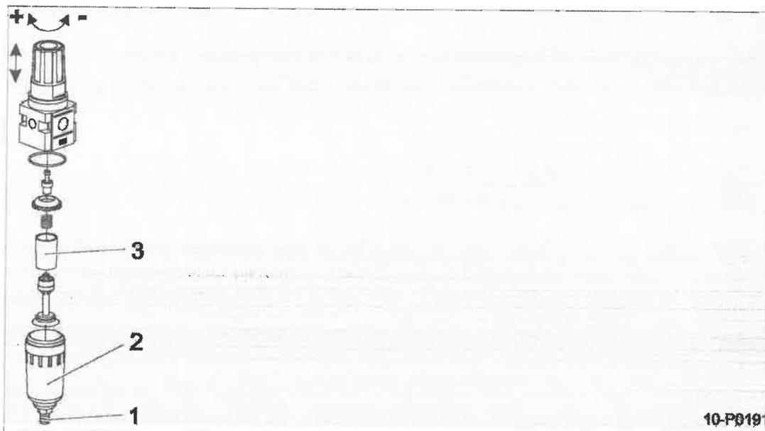
Abb. 19 Filterdruckminderer reinigen
