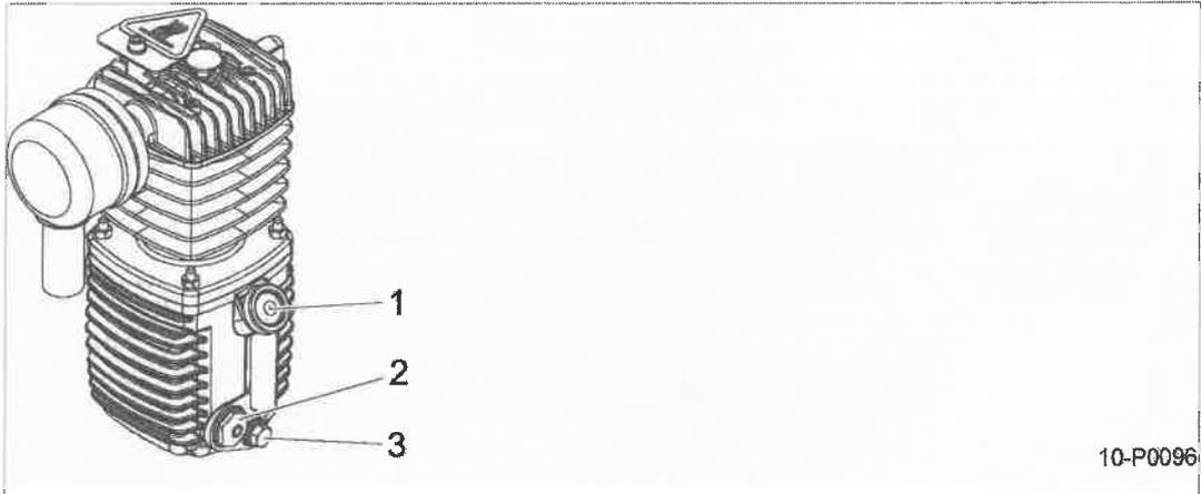
Abb. 14 Kompressoröl wechseln
