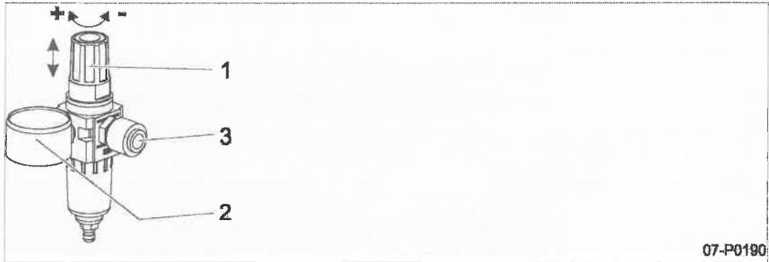
Abb. 8 Filterdruckminderer einstellen
