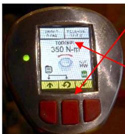
a) die mittlere Tasten unter dem Display drücken
