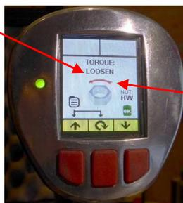
Display wechselt auf **LOOSEN**=(lösen)
