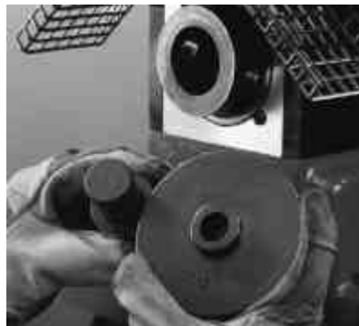
Abb. 22: Überprüfen der Rollen
