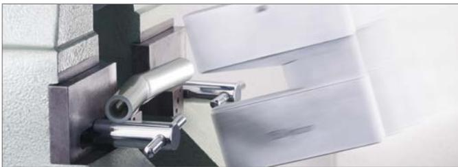
Abb. 3-2 Universalrohr RAUTITAN flex im Kerbschlag-Prüfgerät
