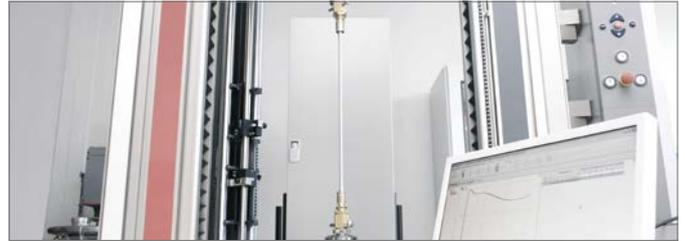
Abb. 3-3 Ablauf eines Zugtests
