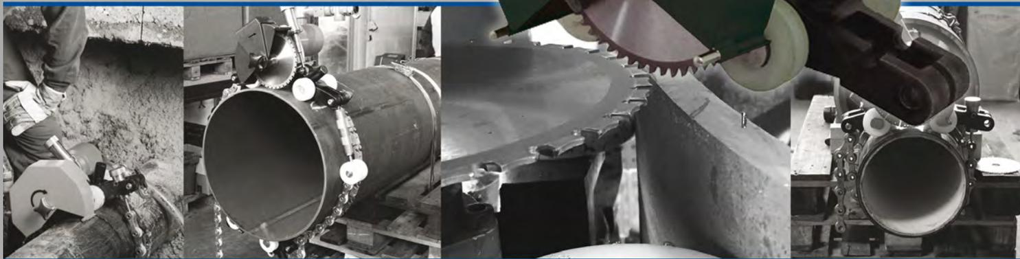
Die mobile kettengeführte Rohrtrennmaschine ist das ideale Werkzeug beim Trennen von Dukt-, Kunststoff-, Stahl- oder Gussrohren bis zu einem Durchmesser von 1600 mm. Erhältlich ist die Rohrtrennmaschine mit Druckluft- oder Hydraulikgetriebe.
