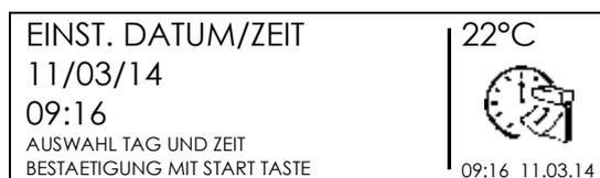
Mit den Pfeilen (▲)(▼) wählen Sie den entsprechenden Wert aus, mit (◀)(▶) bewegen Sie sich durch die Nummernfolge. Bestätigung mit START/OK (I) Taste, Abbruch mit STOP/ESC (O).
