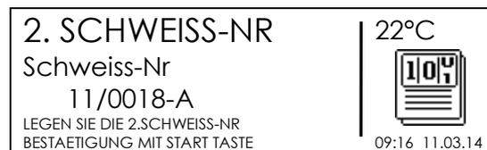
Wird bei der Abfrage der Auftragsnummer eine neue Auftragsnummer eingegeben, so wird die zweite Schweissnummer auf 0000- gesetzt.
