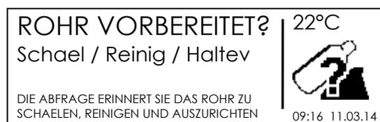
Bei Freigeschalteter Funktion erscheint eine Abfrage der Schweissvorbereitung, diese Abfrage muss mit START/OK ( I ) bestätigt werden.
