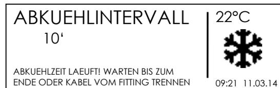
Nach erfolgreicher Schweissung wird die Daten Zusammenfassung und die verbleibende Abkühlzeit abwechselnd angezeigt. Diese Anzeigen bleiben aktiv bis STOP/ESC (O) Taste betätigt wird, um die nächste Verbindung zu starten.
