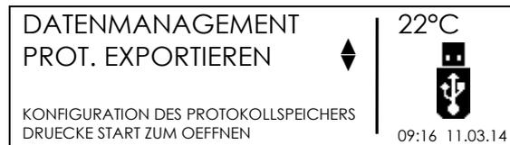
Setzen Sie den USB Stick in die Schnittstelle ein, dann wählen Sie PROT. EXPORTIEREN aus, mit den Pfeiltasten (▲)(▼) wählen Sie das gewünschte Dateiformat für den Export aus.
