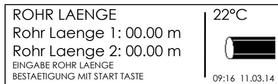
Die Daten können auch manuell eingegeben werden. Es genügt die Pfeiltaste nach rechts (▶) zu drücken, um in den Eingabemodus zu gelangen. Mit den Pfeilen (▲)(▼) wählen Sie die entsprechende Zahl aus, mit (◀)(▶) bewegen Sie sich durch die Nummernfolge. Bestätigung mit START/OK (I) Taste.
