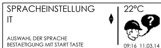
Auswahl der gewünschten Sprache mit (▲)(▼) Tasten, Bestätigung mit START/OK (I) Taste. Zum Verlassen des Menüpunktes ohne zu Speichern STOP/ESC (O) Taste.
