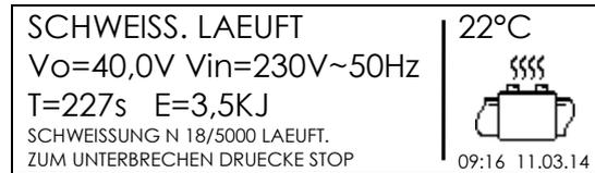
Während des Schweissvorganges wird die Ausgangsspannung, restliche Schweisszeit und Energieeintrag angezeigt.
