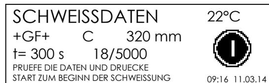
Betätigen Sie die Taste START/OK (I). Das Schweißgerät überprüft den gemessenen Widerstand mit den Werten aus der Barcode Information. Bei Übereinstimmung startet der Schweißprozess automatisch.
