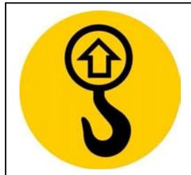
**Mit Hilfe von Gewebehebebänder mit ausreichender Tragkraft und einem Hebezeug mit ausreichender Tragkraft (das Gewicht des Krans finden Sie auf dem Typenschild) dürfen Sie an den gekennzeichneten Stellen das Gerät heben.**
