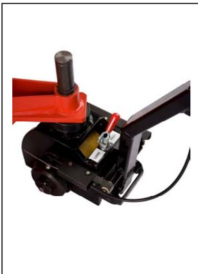
**Lose = Feststeller gelöst, der Kran kann verfahren werden**
