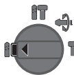
Pozicija za vrtnje brez udarjanja – v les, kovino, keramiko in umetno maso ter za privijanje
