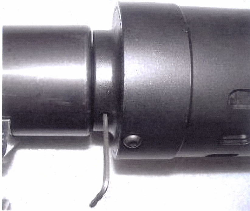
Abb. 21: Festziehen der Mutterschraube des LoadDisc-Antriebs
