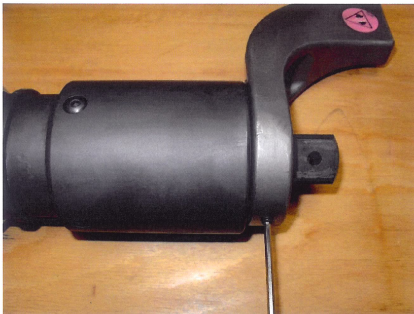
Abb. 6: Halteschraube anziehen und um \frac{1}{4} Umdrehung lösen
