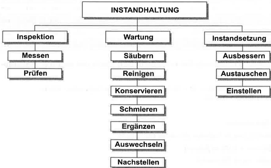
Abb.6-1: Instandhaltung – Definition nach DIN 31051
