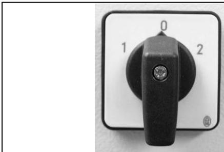
**Drehrichtungswendeschalter** von Position „0“ (Leerlauf) auf Position „1“ oder „2“ drehen.
