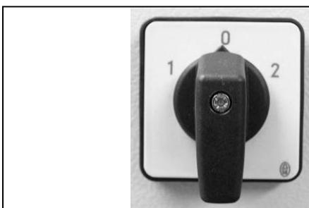
**Drehrichtungswendeschalter** von Position „1“ oder „2“ auf Position „0“ (Leerlauf) drehen.
