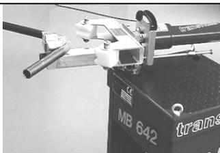
Betätigen Sie den Taster **Biegen zurück**, bis der Gegenhalter komplett zurückgefahren ist.
