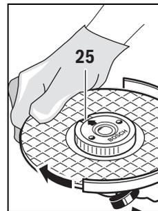
Drücken Sie die Spindel-Arretiertaste **1**, um die Schleifspindel festzustellen. Um die Schnellspannmutter festzustellen, drehen Sie die Schleifscheibe kräftig im Uhrzeigersinn.
