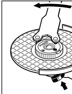
Eine ordnungsgemäß befestigte, unbeschädigte Schnellspannmutter können Sie durch Drehen des Rändelrings entgegen dem Uhrzeigersinn von Hand lösen.
