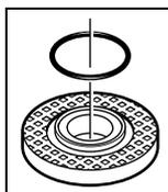
Im Aufnahmeflansch **10** ist um den Zentrierbund ein Kunststoffteil (O-Ring) eingesetzt. **Fehlt der O-Ring oder ist er beschädigt**, muss der Aufnahmeflansch **10** vor der Weiterverwendung unbedingt ersetzt werden.
