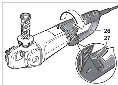
Der Haupthandgriff **26** lässt sich zum Motorgehäuse jeweils um 90° nach links oder rechts drehen. Dadurch kann der Ein-/Ausschalter für besondere Arbeitsfälle in eine günstigere Handhabungsposition gebracht werden, z. B. für Trennarbeiten mit der Absaughaube mit Führungsschlitzen **22** oder für Linkshänder.
