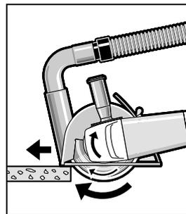
Schalten Sie das Elektrowerkzeug ein und setzen Sie es mit dem vorderen Teil des Führungsschlittens auf das Werkstück. Schieben Sie das Elektrowerkzeug mit mäßigem, dem zu bearbeitenden Material angepasstem Vorschub.
