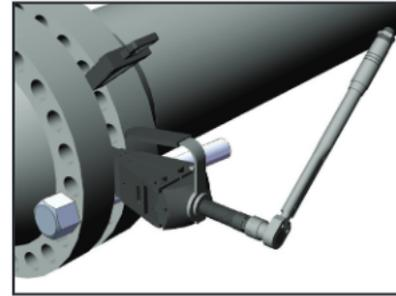
**5.** Der Keil kann dann an der nächsten Stufe eingesetzt werden. Auf diese Weise können Sie die Flanschverbindung bis zur gewünschten Entfernung spreizen.
