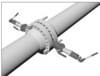
**5.** Nachdem die gewünschte Entfernung - oder der mögliche Verfahrensweg des Keils - erreicht wird, setzen Sie Sicherheitsblöcke in die Flanschverbindung. Wenn sichergestellt ist, dass die Sicherheitsblöcke vollständig eingesetzt sind, können die Werkzeuge vorsichtig eingefahren werden, bis die gesamte Last der Flansche auf den Sicherheitsblöcken liegt.
