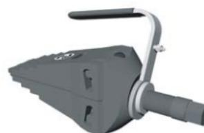
**3.** Es wird dringend empfohlen an der Flanschverbindung zwei SW9TM-Keile, im Winkel von 180° zueinander, zu verwenden.
