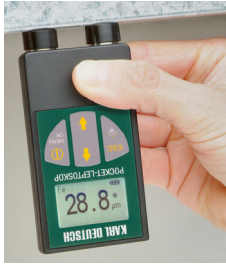
Anzeige um 180° gedreht zum besseren Ablesen bei Messungen über Kopf
