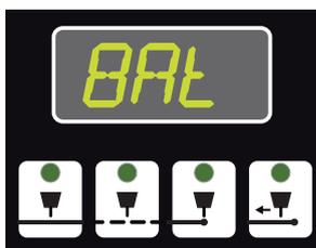
Anzeige blinkt. Der Akkupack ist in Kürze leer. Der Akkupack muss dem Fahrwerk entnommen und aufgeladen werden.
