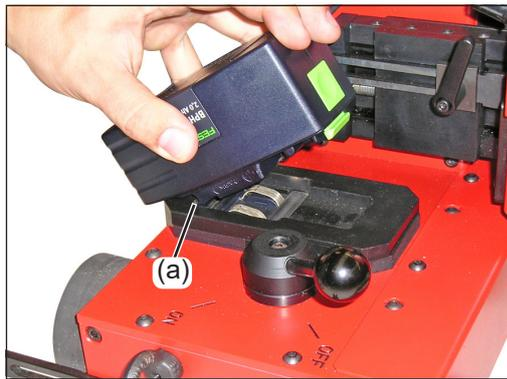
Akkupack in Fahrwerkschacht einhängen
