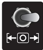
2. Kippschalter „Start LINKS / STOP / Start RECHTS“ in die gewünschte Richtung drücken - Testablauf startet. Zum vorzeitigen Stoppen auf Stellung „STOP“ (0) schalten.
