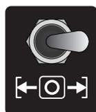
2. Kippschalter „Start LINKS / STOP / Start RECHTS“ in die gewünschte Richtung drücken - Schweißablauf startet. Zum vorzeitigen Stoppen auf Stellung „STOP“ (0) schalten.
