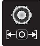
2. Taste „SELECT / ENTER“ 3 Sekunden drücken, Parametereingabe ist freigegeben. Nach jedem Einstieg wird automatisch der Parameter „Schweiß-Segment“ angezeigt. Taste „SELECT / ENTER“ erneut drücken und „Pause-Segment“ anwählen.
