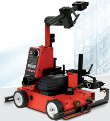
/ Das magnetische Fahrwerk FDV 22 MF ist universell zum mechanisierten Längsnahtschweißen (MIG/MAG) einsetzbar. Ein integrierter Permanentmagnet sorgt für eine optimale Traktion der Räder selbst im vertikalen Einsatz.
