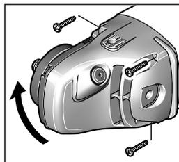
Hlavu převodovky můžete otočit v krocích po  $90^\circ$ . Tím lze uvést spínač pro zvláštní případy práce do výhodnější manipulační polohy, např. pro dělicí práce s odsávacím krytem s dělicími saněmi 24 nebo pro leváky.
