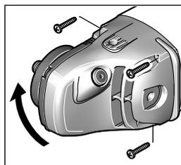
Prevodovú hlavu môžete otáčať po krokoch v hodnote 90° stupňov. Takýmto spôsobom si môžete v špeciálnych prípadoch nastaviť vypínač do výhodnejšej polohy, napríklad pri rezaní s odsávacím krytom pomocou vodiacich saní 24, alebo ak ste ľavákom.
