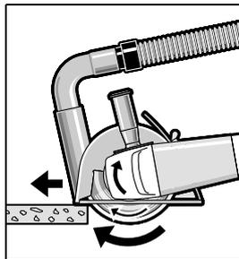
Koppla på elverktyget och lägg an det med styrslidens främre del mot arbetsstycket. Mata fram elverktyget med måttlig och en till materialet anpassad hastighet.
