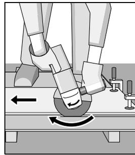
Az elektromos kéziszerszámot mindig a forgással ellenkező irányba kell vezetni. Ellenkező esetben a készülék **irányíthatatlanul** kiugorhat a vágásból.
