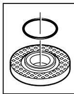
V upínacej príрубе **7** je okolo centrovačieho nástavca vložený element z plastu (okružla podložka). **Ak táto okružla podložka chýba, alebo ak je poškodená,** upínaciu prírubu **7** treba pred ďalším používaním bezpodmienečne vymeniť za novú.
