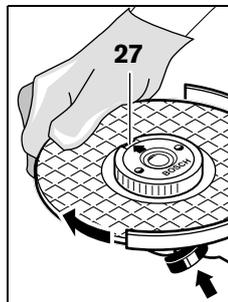
Tryk på spindel-låsetasten **1** for at justere slibespindlen. Lynspændemøtrikken spændes ved at dreje slibeskiven kraftigt mod højre.
