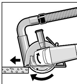
Tænd for el-værktøjet og anbring den forreste del af føringsslæden på emnet. Skub el-værktøjet frem med jævn fremføring, der passer til det materiale, der skal bearbejdes.
