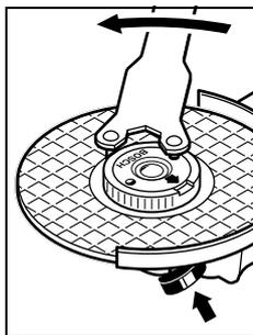
Una tuerca de fijación rápida, correctamente montada, puede aflojarse a mano girando el anillo moleteado en sentido contrario a las agujas del reloj.
