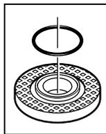
Balstaplāksnes **7** centrējošo izcilni aptver plastmasas detaļa (0 veida gredzens). **Ja 0 veida gredzens trūkst vai arī tas ir bojāts**, balstaplāksne **7** pirms instrumenta tālākas lietošanas noteikti jānomaina.
