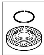
Un joint en plastique (rondelle élastique) est directement monté autour de l'alésage du flasque **7**. **Au cas où cette rondelle élastique fasse défaut ou qu'elle soit endommagée**, il faut absolument remplacer la flasque d'entraînement **7** avant de continuer à l'utiliser l'outil.
