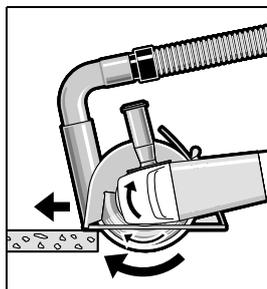
Elektrinį įrankį įjunkite ir kreipiamųjų pavažų prie-kine dalimi uždėkite ant ruošinio. Stumkite elek-trinį įrankį pagal apdoro-jamą paviršių pritaikyta pastūma.
