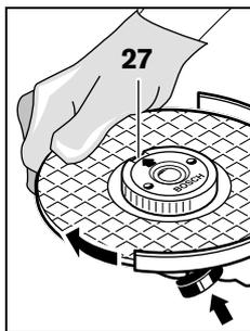
Ustalić położenie wrzeciona za pomocą przycisku blokady 1. Nakrętkę szybkomocującą dociągnąć, mocno przekręcając tarczę szlifierską w kierunku zgodnym z ruchem wskazówek zegara.
