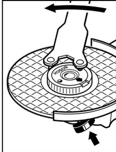
Oikein kiinnitetyn, vaurioitumattoman pikakiinnitysmutterin voit irrottaa sormivoimin kiertämällä uurrettua rengasta vastapäivään. **Älä koskaan irrota kiinnijuuttunutta pikakiinnitysmutteria pihdeillä, vaan käytä sakara-avainta.** Aseta sakara-avain mutteriin kuvan osoittamalla tavalla.
