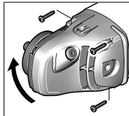
Du kan vrida växelhuvudet i steg om  $90^\circ$ . Detta medger att strömställaren kan ställas i ett för hanteringen gynnsamt läge, t. ex. för kapning med sugkåpa och styrslid **24** eller för vänsterhanta.
