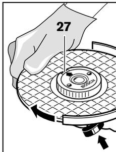
Druk op de asbloekeer-knop **1** om de uitgaande as vast te zetten. Om de snelspanmoer vast te draaien, draait u de slijpschijf krachtig met de wijzers van de klok mee.
