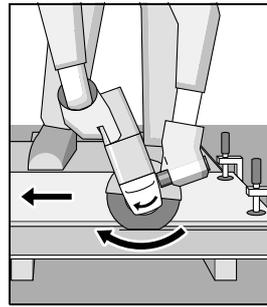
Elektrikli el aleti daima dönme yönünün tersine yönlendirilmelidir. Aksi takdirde alet **kontrol-dan** ve kesme hattından çıkabilir.
