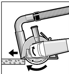
Zapnite ručné elektrické náradie a priložte ho prednou časťou vodiacich saní na obrobok. Miernym posuvom, ktorý zodpovedá obrábanému materiálu, prísúvajte náradie k obrobku.
