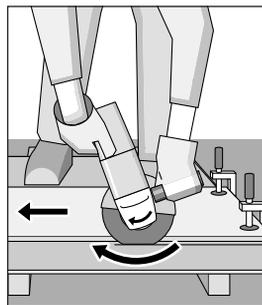
هنگام برش پروفیل ها و لوله های چهارضلعی، بهتر است از کوچکترین ضلع مقطع برش شروع بکار کنید.
