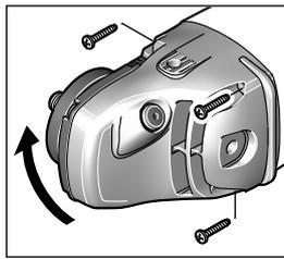
Sie können den Getriebekopf in 90°-Schritten drehen. Dadurch kann der Ein-/Ausschalter für besondere Arbeitsfälle in eine günstigere Handhabungsposition gebracht werden, z. B. für Trennarbeiten mit der Absaughaube mit Führungsschlitten 24 oder für Linkshänder.
