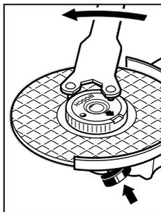
Prawidłowo zamocowana, nieuszkodzona nakrętka mocująca pozwala się łatwo poluzować ręką, poprzez obracanie pierścieniem radełkowym w kierunku przeciwnym do ruchu wskazówek zegara. **Mocno dokręconej nakrętki nie zwalniać nigdy za pomocą szczypiec lub kombinerek. Stosować wyłącznie klucz dwutrzipniowy.** Klucz nasadzać, jak pokazano na rysunku.
