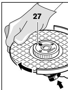
Trykk spindel-låsetasten 1 for å låse slipespindelen. Til fasttrekking av hurtiglåsen, dreier du slipeskiven kraftig i urviserretning.
