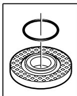
На опорном фланце 7 вокруг центрального буртика находится пластмассовая деталь (кольцо круглого сечения). Если кольцо круглого сечения отсутствует или повреждено, опорный фланец 7 необходимо обязательно заменить перед дальнейшим применением.
