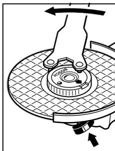
Řádně upevněnou, nepoškozenou rychloupínací matici můžete uvolnit rukou otáčením rýhovaného kroužku proti směru hodinových ručiček. **Pevně usazenou rychloupínací matici nikdy neuvolňujte pomocí kleští, nýbrž použijte klíč se dvěma čepy.** Klíč se dvěma čepy nasadte jak je zobrazeno na obrázku.
