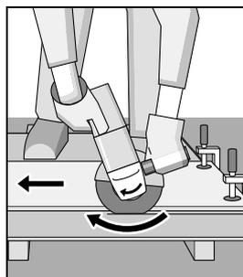
Električni alat mora se uvijek voditi protuhodno. Međutim postoji opasnost da se **nekontrolirano** istisne iz reza.
