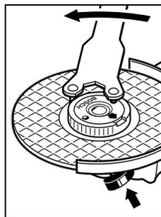
Propisno pričvršćenu neoštećenu brzostežuću maticu možete otpustiti okretanjem nareckanog prstena u smjeru suprotnom od kazaljke na satu.
