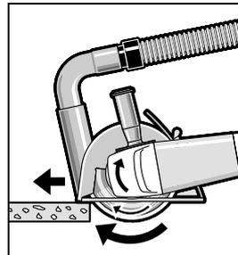
Kapcsolja be az elektromos kéziszerszámot és helyezze fel a vezetőszánnal első részével a megmunkálásra kerülő munkadarabra. Az elektromos kéziszerszámot a megmunkálásra kerülő anyagnak megfelelő mérsékelt előtolással mozgassa előre.
