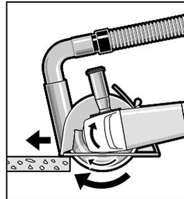
Θέστε το ηλεκτρικό εργαλείο σε λειτουργία και ακουμπήστε το με το μπροστινό μέρος του συρόμενου οδηγού επάνω στο υπό κατεργασία τεμάχιο. Ωθείστε το ηλεκτρικό εργαλείο με μέτρια πρόωση, προσαρμοσμένη στο υπό κατεργασία υλικό.
