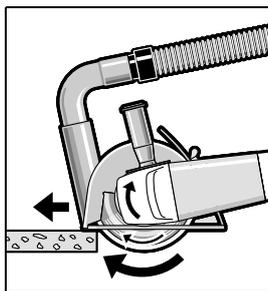
Avviare l'elettrotroutensile ed applicarlo con la parte anteriore della slitta di guida sul pezzo in lavorazione. Spingere l'elettrotroutensile avanzando moderatamente ed adattando il movimento al materiale in elaborazione.
