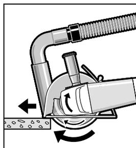
Mettez l'outil électroportatif en marche et positionnez-le avec la partie avant de la glissière de guidage sur la pièce à travailler. Travaillez en appliquant une vitesse d'avance modérée adaptée au matériau.
