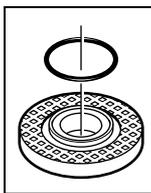
W kołnierzu **7**, w podtoczeniu znajduje się okrągły pierścień uszczelniający (tzw. o-ring). **Jeżeli brakuje tej uszczelki, lub jest ona uszkodzona, kołnierz mocujący **7** należy koniecznie wymienić przed przystąpieniem do dalszej eksploatacji narzędzia.**
