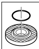
I stödfälansen **7** är kring centreransatsen en plastdel (O-ring) insatt. **Om O-ringen saknas eller är skadad** måste stödfälansen **7** före fortsatt användning ovillkorligen bytas.
