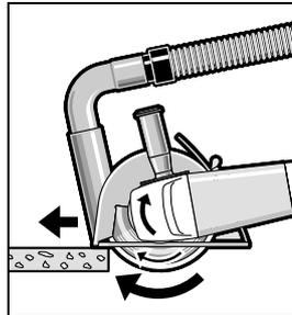
Вклучете го електричниот апарат и поставете го со предниот дел на лизгачките водилки на делот што се обработува. Поместувајте го електричниот апарат со умерено движење по материјалот што се обработува.
