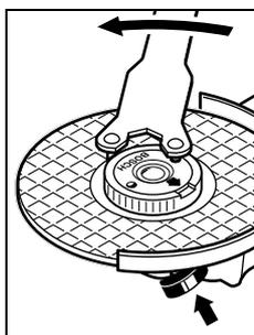
En ordentligt fastspänd och oskadad snabbspännmutter kan för hand s när den räfflade ringen vrids moturs. **Lossa aldrig en hårsittande snabbspännmutter med tång utan använd flämsmutternyckeln.** Lägg an flämsmutternyckeln som bilden visar.
