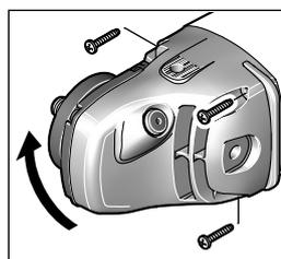
Du kan dreie girhodet i 90°-skritt. Slik kan på-/av-bryteren settes i en bedre håndteringsposisjon for spesielle arbeidssituasjoner, f. eks. for kapping med avsugdekslet med føringsleiden 24 eller for venstre-hendte.
