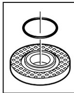
In de opnameflens **7** is rondom de centreerkraag een kunststof onderdeel (O-ring) ingezet. **Als de O-ring ontbreekt of beschadigd is**, moet de opnameflens **7** beslist worden vervangen voordat het gereedschap verder wordt gebruikt.
