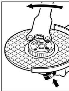
Затегната правилно, неповредена гайка за бързо застопоряване може да бъде развита чрез завъртане на ръка на накатения пръстен в посока, обратна на часовниковата стрелка.
