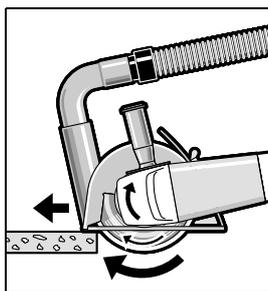
Włączyć elektronarzędzie i przyłożyć przednią część przewodnicy do ciętego elementu. Pracować z równomiernym, optymalnie dopasowanym do danego typu materiału posuwem.
