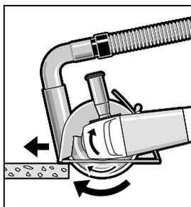
Porniți scula electrică și puneți-o cu partea anterioară a saniei de ghidare pe piesa de lucru. Împingeți scula electrică cu avans moderat, adaptat materialului de prelucrat.
