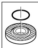
No flange de fixação **7** encontra-se uma gola de centragem (anel circular). **Se o anel circular estiver faltando ou se estiver danificado**, terá que substituir sem falta o flange de fixação **7** antes de continuar a usar o aparelho.
