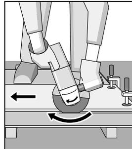
Das Elektrowerkzeug muss stets im Gegenlauf geführt werden. Es besteht sonst die Gefahr, dass es **unkontrolliert** aus dem Schnitt gedrückt wird.
