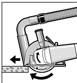
Ieslēdziet elektroinstrumentu un novietojiet vadotnes priekšējo daļu uz griezamā priekšmeta. Vienmērīgi virziet elektroinstrumentu pa griezamo priekšmetu ar mērenu ātrumu, kas atbilst griezamā materiāla īpašībām.
