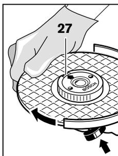
Stlačte aretační tlačítko vřetene 1, aby se brusné vřeteno zajistilo. Pro pevné utažení rychloupínací matice otočte brusný kotouč silou ve směru hodinových ručiček.
