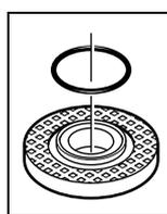
En la base del cuello de centrado de la brida de apoyo **7** va alojada una pieza de plástico (anillo tórico). **Si este anillo tórico faltase o estuviese deteriorado**, es imprescindible reemplazar la brida de apoyo **7** por otra en perfectas condiciones.
