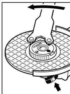
Správne upevnená a nepoškodená rýchlopínacia matica sa dá uvoľniť rukou otočením ryhovaného prstenca proti smeru pohybu hodinových ručičiek.
