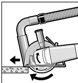
Uključite električni alat i stavite ga sa prednjim delom klizača vodjice na radni komad. Gurajte električni alat sa umerenim pomeranjem napred koje je prilagodjeno materijalu koji se obradjuje.
