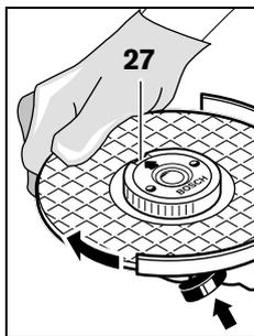
Натиснете бутона за блокиране на вала 1 за да го застопорите. За да затегнете гайката за бързо застопоряване, завъртете диска силно по посока на часовниковата стрелка.
