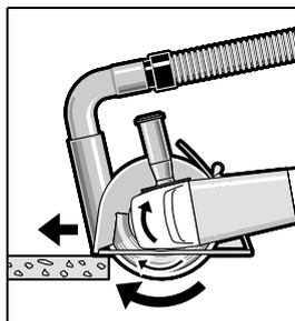
Uključite električni alat i stavite ga na izradak sa prednjim dijelom vodilica. Pomikajte električni alat sa umjerenim posmakom prilagođenim obrađivanom materijalu.
