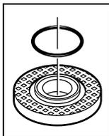
Kiinnityslaipassa **7** on muoviosa (O-renkas) keskityslaipan ympäri. **Jos tämä O-renkas puuttuu tai on vaurioitunut, vaihda se ehdottomasti ennen kiinnityslaipan 7 asennusta.**
