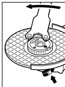
En korrekt fastgjort, ubeskadiget lynspændemøtrik løsnes ved at dreje fingerringen mod venstre.
