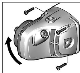
Il est possible de faire pivoter le carter d'engrenage par paliers de 90°. Ceci permet de mettre l'interrupteur Marche/Arrêt dans une position de maniement favorable à des utilisations spécifiques, p. ex. pour des travaux de tronçonnage effectués au moyen du
