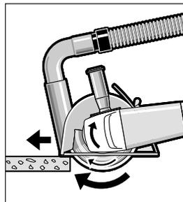
هنگام برش مواد سخت، از جمله بتن با مقدار خرده سنگ بالا، ممکن است صفحه برش الماسه بسیار داغ شده و صدمه ببیند. جرقه های حلقه واری که دور صفحه برش الماسه بوجود میآیند، نمایانگر این امر می باشد. در اینصورت برش کاری را قطع کنید و بگذارید صفحه برش الماسه برای مدت کوتاهی با حداکثر سرعت در حالت آزاد کار کند تا خنک شود.
