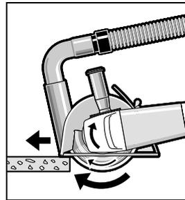
Käynnistä sähkötyökalu ja aseta se ohjainkelkan etuosa edellä työkappaleen vasten. Työnnä sähkötyökalua käyttäen kohtuullista, työstettävään materiaaliin soveltuvaa syöttönopeutta.
