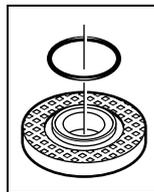
I tangen **7** er det satt inn en kunststoffdel (O-ring) rundt senteringskanten. **Hvis O-ringen mangler eller er skadet, må tangen 7 absolutt skiftes ut før videre bruk.**
