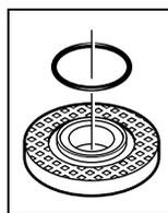
În flanșa de prindere **7**, în jurul gulerului de centrare este montată o piesă din plastic (garnitură inelară). **În cazul în care garnitura inelară lipsește sau este deteriorată**, flanșa de prindere **7** trebuie neapărat înlocuită înainte de reutilizare.
