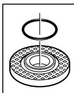
U steznoj prirubnici **7** oko naslona za centriranje ugrađen je plastični dio (O-prsten). **Ako O-prsten nedostaje ili je oštećen**, prije daljnje primjene, stezna prirubnica **7** se mora neizostavno zamijeniti.
