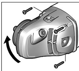
Voit kääntää vaihepäättä 90°-portaissa. Täten voidaan käynnistyskytkin kääntää parempaan käyttöasentoon eri työtapauksissa, esim. katkaisutyössä imuhupulla varustettua ohjauskelkkaa 24 käyttäen tai vasenkätisille.
