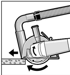
Schakel het elektrische gereedschap in en plaats het met het voorste deel van de geleidingslede op het werkstuk. Duw het elektrische gereedschap verder met een matige voorwaartse beweging, aangepast aan het te bewerken materiaal.
