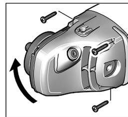
Головку редуктора можна повертати з інтервалом у 90°. Завдяки цьому вимикач буде знаходитися у більш зручному для певних видів роботи положенні, напр., при розрізанні з витяжним ковпаком з люнетним супортом **24** або якщо Ви лівша.
