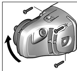
Głowica przekładni obracana jest w czterech skokach (co  $90^\circ$ ). Pozwala to na ustawienie włącznika/wyłącznika w wygodniejszej pozycji roboczej w przypadku specyficznych zastosowań, np. podczas cięcia przy użyciu pokrywy odsysającej z przewodniczą saneczką 24, a także dla osób leworęcznych.
