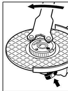
Eine ordnungsgemäß befestigte, unbeschädigte Schnellspannmutter können Sie durch Drehen des Rändelringes entgegen dem Uhrzeigersinn von Hand lösen.
