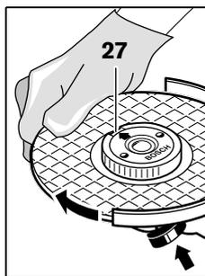
Для фиксации шлифовального шпинделя нажмите кнопку фиксации шпинделя 1. Для затягивания быстрозажимной гайки поверните шлифовальный круг с усилием по часовой стрелке.
