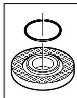
В опорному фланці **7** на центруючому пояску знаходиться пластмасова деталь (кільце круглого перерізу). Якщо кільце круглого перерізу відсутнє або пошкоджене, опорний фланець **7** необхідно обов'язково замінити перед подальшим використанням.
