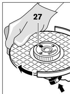
بلک مهره مهار سریع (مهره SDS) بدون نقص که به درستی محکم شده است، را میتوانید بوسیله دست از طریق پرخش حلقه شیاردار آن، در خلاف جهت حرکت عقربه ساعت باز کنید.
