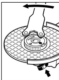
Een op de juiste manier bevestigde en onbeschadigde snelspanmoer kunt u los-draaien door de kartelring tegen de wijzers van de klok in met de hand los te draaien. **Draai een vastzittende snelspanmoer nooit met een tang los, maar gebruik de pensleutel.** Plaats de pensleutel zoals op de afbeelding getoond.
