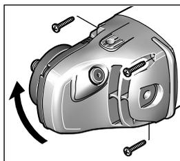
Du kan dreje gearhovedet i skridt på  $90^\circ$ . Dette gør det muligt at stille start-stop-kontakten i en særlig praktisk position, når særligt arbejde skal udføres; f.eks. til skæring med opslugningskappen med føringsslæde **24** eller til venstrehåndede.
