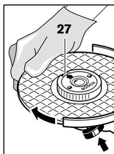
Za zaustavljanje vretena pritisnite tipku za uglavljivanje vretena **1**. Za stezanje brzostežuće matice okrenite brusnu ploču snažno u smjeru kazaljke na satu.
