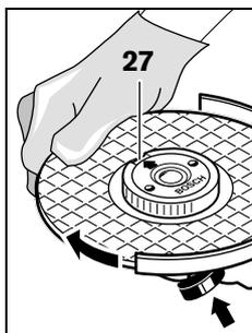
Lai nekustīgi nostiprinātu elektroinstrumenta darbvārpstu, nospiediet darbvārpstas fiksēšanas taustiņu 1. Lai pieskrūvētu rokas piespiedējuzgriezni, spēcīgi grieziet slīpēšanas disku pulksteņa rādītāju kustības virzienā.
