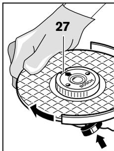
Натисніть на фіксатор шпинделя **1**, щоб зупинити шліфувальний шпиндель. Для затягнення швидкозатискної гайки з силою поверніть шліфувальний круг за стрілкою годинника.
