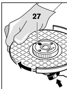
Premir a tecla de bloqueio do veio 1 para imobilizar o veio de rectificação. Girar o disco abrasivo fortemente no sentido dos ponteiros do relógio para apertar a porca de aperto rápido.
