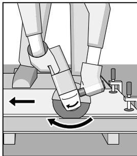
Con l'elettrotroutensile si deve sempre operare con fresatura bidirezionale. In caso contrario vi è il pericolo che la macchina possa essere spinta in modo **non controllato** fuori della linea di taglio.
