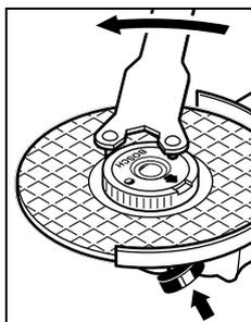
Правильно закрепленную, не имеющую повреждений быстрозажимную гайку Вы можете отвернуть, вращая рукой кольцо с накаткой против часовой стрелки.
