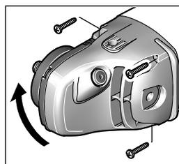
O cabeçote de engrenagens pode ser girado em passos de  $90^\circ$ . Desta forma é possível colocar o interruptor de ligar-desligar numa posição mais propícia para certos trabalhos especiais, p. ex. para trabalhos de corte com a capa de aspiração com carril de guia 24 ou para esquadros.
