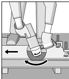
Met het elektrische gereedschap moet altijd tegenlopend worden geslepen. Anders bestaat het gevaar dat de machine **ongecontroleerd** uit de zaaglijn wordt geduwd.
