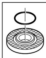
На центровачщото стъпало на фланеца **7** е поставен уплътнителен елемент (O-пръстен). **Ако O-пръстенът липсва или е повреден, преди използване на електроинструмента центровачният фланец 7 трябва задължително да бъде заменен.**
