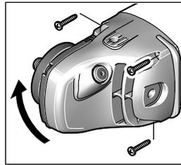
Μπορείτε να γυρίσετε την κεφαλή συμπλέκτη βαθμωδών ανά 90°. Έτσι μπορείτε, σε περιπτώσεις διεξαγωγής ειδικών εργασιών, π. χ. σε εργασίες κοπής με το κάλυμμα αναρρόφησης με συρόμενο οδηγό 24 ή για εργασίες για αριστερόχειρες, να θέσετε το διακόπτη ON/OFF σε μια ανάλογα ευνοϊκότερη θέση.
