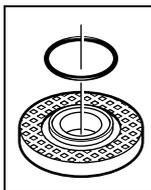
Nella flangia di supporto **7** è applicato intorno al collare di centraggio un elemento di plastica (o-ring). **Se l'o-ring manca oppure è danneggiato, la flangia di supporto 7 deve essere assolutamente sostituita prima di proseguire con l'uso.**
