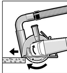
Schalten Sie das Elektrowerkzeug ein und setzen Sie es mit dem vorderen Teil des Führungsschlittens auf das Werkstück. Schieben Sie das Elektrowerkzeug mit mäßigem, dem zu bearbeitenden Material angepasstem Vorschub.
