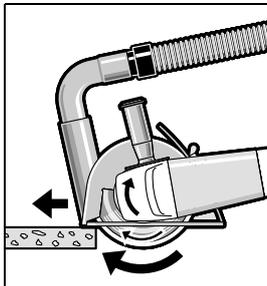
Conecte la herramienta eléctrica y asiente la parte anterior del soporte guía sobre la pieza. Desplace la herramienta eléctrica con un avance moderado adecuado al tipo de material a trabajar.
