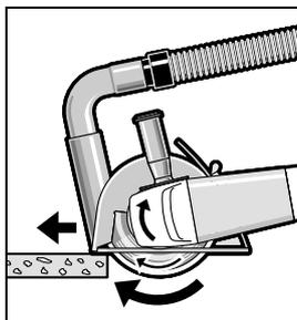
Включете електроинструмента и поставете предната част на направляващата шейна върху детайла. Придвижвайте електроинструмента с умерено, съобразено с обработвания материал подаване.
