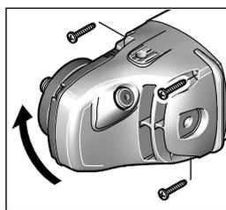
Elektroinstrumenta pārnesuma galva ir pagriežama ar soli 90°. Tas spēj atvieglot darbu īpašās situācijās, jo lietotājam ir iespēja izvēlēties izdevīgāko ieslēdzēja novietojumu, piemēram, darbinot elektroinstrumentu kopā ar griešanas aizsargpārsegu ar putekļu uzsūkšanu un griešanas vadotni 24, kā arī gadījumos, ja elektroinstrumentu lieto kreilis.
