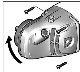
Можете да завъртите главата на редуктора на стъпки от по 90°. Така при специални работни условия пусковият прехвърляч може да бъде поставен в по-удобна позиция, напр. при рязане с използване на предпазния кожух с прахоулавяне и водеща шейна 24 или ако работите с лявата ръка.
