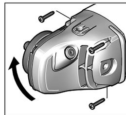
Погонската глава може да ја вртите на  $90^\circ$ -нивоа. Притоа, прекинувачот за исклучување/вклучување може да се постави во поповолна позиција при изведување на посебни случаи на работа, на пр. сечење со хауба за вшмукување со лизгачка водилка 24 или за левораки лица.
