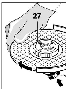
A csiszolótengely rögzítéséhez nyomja meg az 1 tengelyrögzítógombot. A gyorsbefogó anya megszorításához fordítsa el a csiszolótárcsát erőteljesen az óramutató járásával megegyező irányban.
