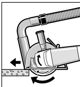
Vklopite električno orodje in ga s sprednjim delom drsnega vodila postavite na obdelovane. Električno orodje pomikajte z zmernim pomikom, ki ga morate prilagoditi materialu, ki ga obdelujete.
