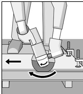
Електричниот апарат секогаш мора да се води во спротивен правец на движење. Инаку постои опасност, тој **неконтролирано** да се истисне од резот.
