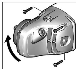
Možete glavu prenosioca okretati u  $90^\circ$  podeoka. Na taj način se prekidač za uključivanje-isključivanje za posebne radne slućajeve dovodi u povoljniju poziciju za rukovanje, na primer za radove presećanja sa usisavajućom haubom sa klizajućom vodjicom **24** ili za levoruke.
