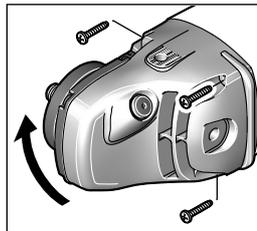
U kunt de machinekop in stappen van  $90^\circ$  draaien. Daardoor kunt u de aan/uit-schakelaar voor bijzondere werkzaamheden in een gunstige bedieningspositie brengen, bijvoorbeeld voor doorslijpwerkzaamheden met de afzuigkap met geleidings-slede **24** of voor werkzaamheden met de linkerhand.
