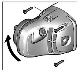
È possibile ruotare la testata ingranaggi in segmenti di  $90^\circ$ . In questo modo l'interruttore di avvio/arresto può essere posizionato, per casi operativi particolari, in una posizione di maneggio più favorevole, p. es. per lavori di troncatrice con la cuffia di aspirazione con
