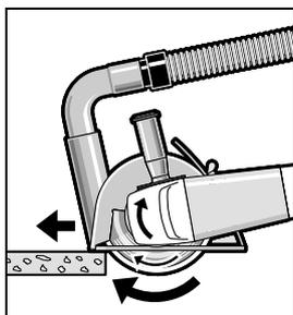
Включите электроинструмент и установите его передней частью направляющих салазок на деталь. Перемещайте электроинструмент с умеренной, соответствующей обрабатываемому материалу подачей.
