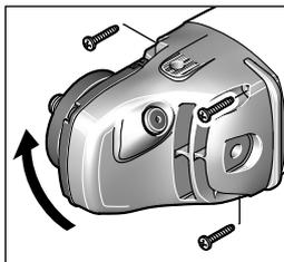
Es posible girar el cabezal del engranaje en pasos de  $90^\circ$ . Ello le permite colocar el interruptor de conexión/desconexión en una posición de operación más cómoda si es Ud. zurdo, o al realizar ciertos trabajos especiales como, p. ej., al tronzar con la caperuza de aspiración con el soporte guía **24**.
