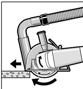
Slå på elektroverktøyet og sett det med fremre del av føringsleiden på arbeidsstykket. Skyv elektroverktøyet fremover med middels sterk kraft som er tilpasset materialet som skal bearbejdes.
