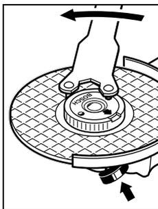
Jednu propisno učvršćenu, neoštećenu navrtku sa brzim zatezanjem možete rukom odvrnuti okretanjem nareckanog prstena nasuprot smeru kazaljke na satu.
