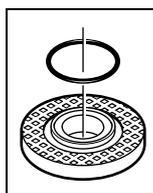
V upínací přírubě **7** je kolem středícího osazení vložen díl z umělé hmoty (o-kroužek). **Pokud o-kroužek chybí nebo je poškozen**, musí být před dalším používáním upínací příruba **7** bezpodmínečně vyměněna.
