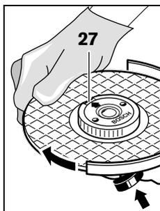
Tryck på spindelns låsknapp **1** för låsning av slippindel. För åtdragning av snabbspännmuttern vrid slipskivan kraftigt medurs.
