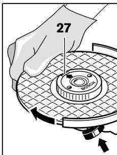
Pritisnite taster za blokadu vretena **1** da bi utvrdili brusno vreteno. Da bi stegli navrtku sa brzim zatezanjem, okrenite brusnu ploču snažno u pravcu kazaljke na satu.
