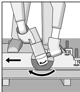
Električno orodje vedno premikajte protismerno. V nasprotnem primeru obstaja nevarnost, da bo **nekontrolirano** izpadlo iz reza.
