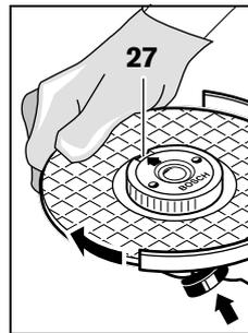
Drücken Sie die Spindel-Arretiertaste **1**, um die Schleifspindel festzustellen. Um die Schnellspannmutter festzuziehen, drehen Sie die Schleifscheibe kräftig im Uhrzeigersinn.
