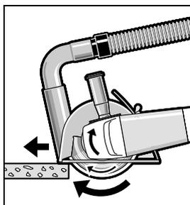
Ligar a ferramenta eléctrica e colocá-la com a parte dianteira do carril de guia sobre a peça a ser trabalhada. Empurrar a ferramenta eléctrica com avanço moderado, adequado ao material a ser trabalho.
