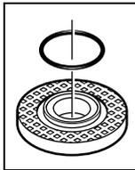
Im Aufnahmeflansch **7** ist um den Zentrierbund ein Kunststoffteil (O-Ring) eingesetzt. **Fehlt der O-Ring oder ist er beschädigt**, muss der Aufnahmeflansch **7** vor der Weiterverwendung unbedingt ersetzt werden.
