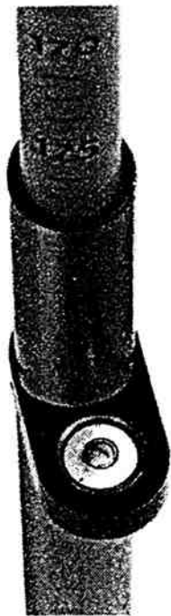
Bild 5 Eingespielte Dosenlibelle am Zentrierstock. Die Instrumentenhöhe wird am unteren Ende der cm-Teilung abgelesen, hier 178 cm
