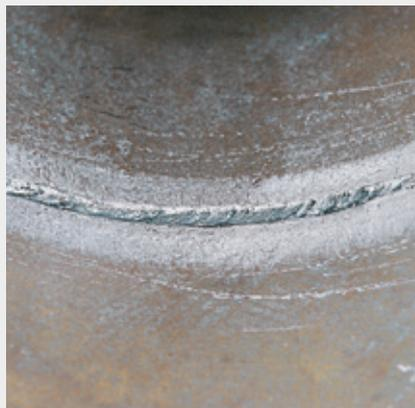
/ Auch beim Schweißen von Rohrleitungen mit Cel-Elektroden begeistert das Ergebnis. Durch die optimalen Eigenschaften des Lichtbogens wird das Abreißen und Festkleben der Elektrode verhindert. Das Ergebnis – eine vollkommen homogene Wurzel.
