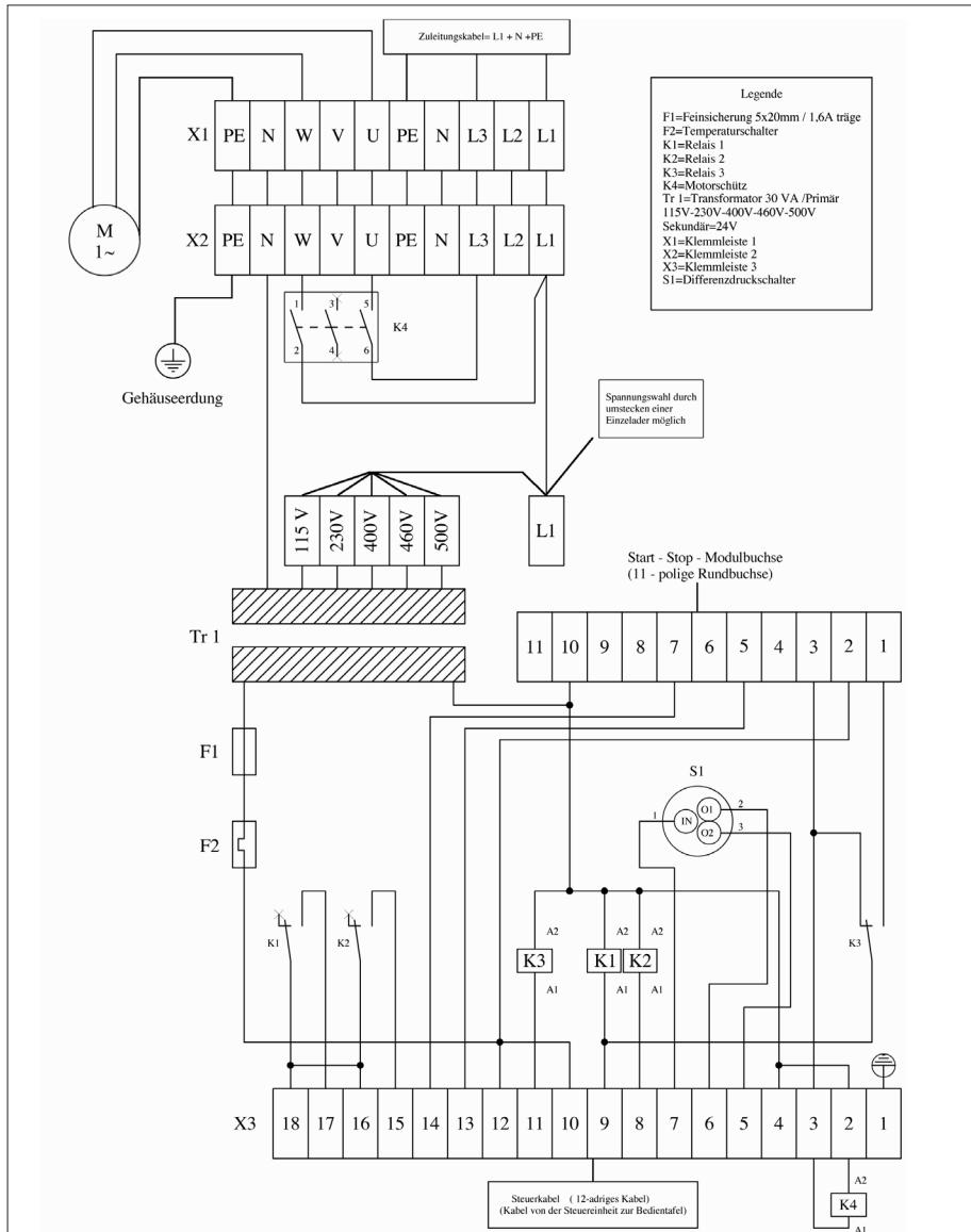
**Schaltpläne / Wiring diagram / Schéma de câblage / Esquemas de Cableado
