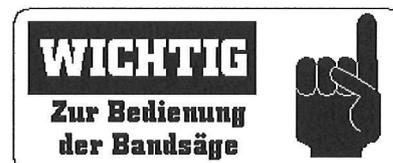
**Keine der Schutzeinrichtungen darf umgangen oder unwirksam gemacht werden**
