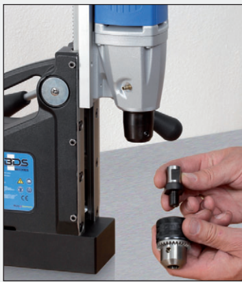
1. Adapter mit Bohrfutter verbinden.
