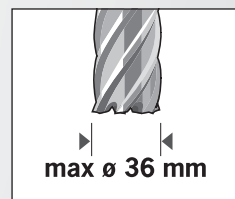
Kernbohren bis ø 35 mm
