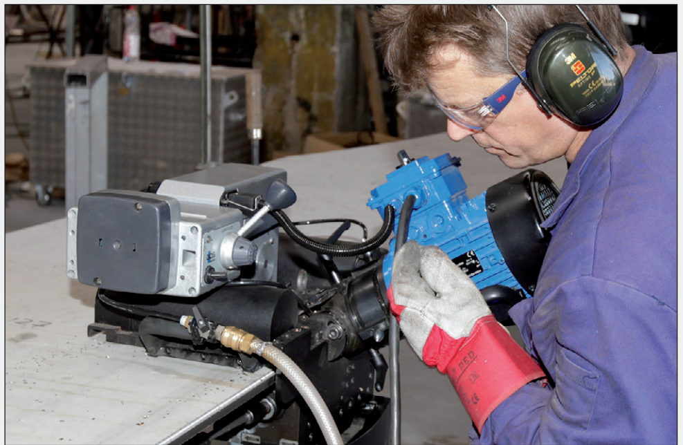
Die AutoCUT 500 mit automatischem Vor- und Rücklauf
