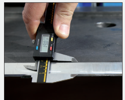
Fasenbreite max. 30 mm
