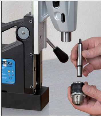
1. Kegeldorn mit Bohrfutter verbinden.
