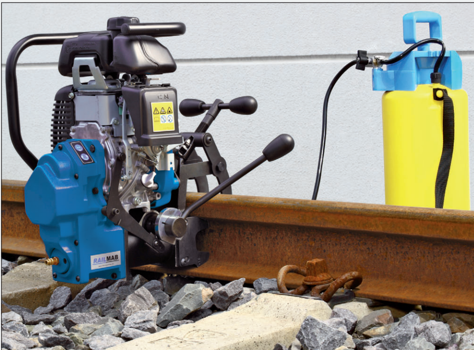
RailMAB 600 mit Benzinmotor. Leistung 1,5 kW, Drehmoment 3,04 Nm.
