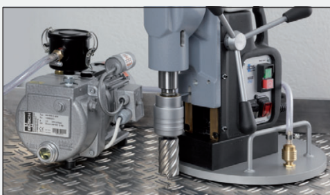
ZAV 300 Vakuumschraubvorrichtung für Riffel- und Kreuzbleche
