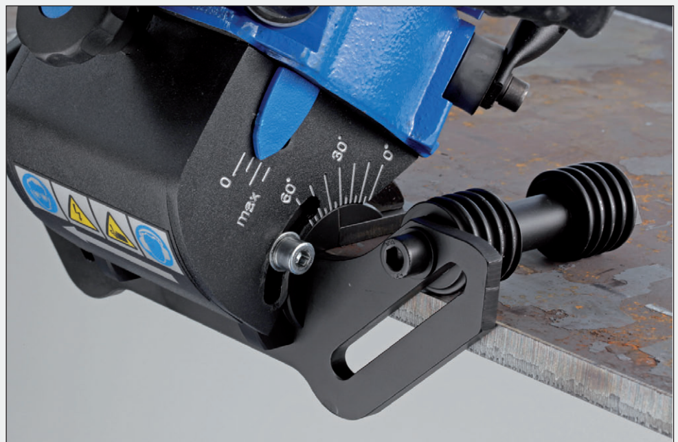
Breite Führungsrollen und die stufenlose Winkeleinstellung von 15 bis 60° machen das System praktikabel.
