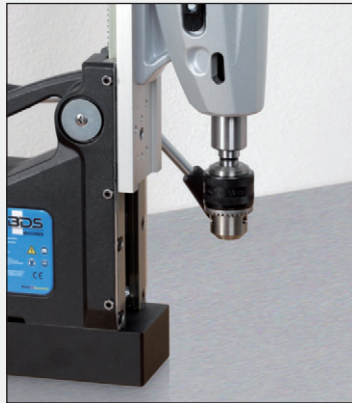
2. Bohrfutter in MK-Aufnahme einsetzen.
