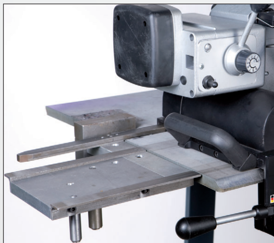
Führungsschiene der AutoCUT 500
