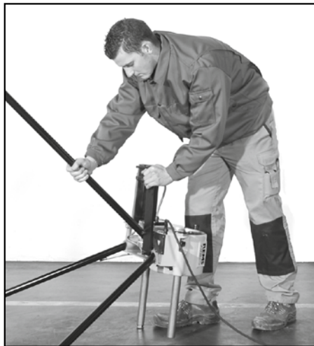
Fig. 1: RohrfüÙe einstecken Fig. 1: Inserting the tubular legs Fig. 1: Engager les pieds tubulaires Fig. 1: Infilare le gambe di supporto Fig. 1: Introducir las patas tubulares Fig. 1: Steunpoten insteken Fig. 1: Isättning av benen Fig. 1: Montering av rørben Fig. 1: Indstikning af rørben Kuva 1: Putkijalkojen asennus Fig. 1: Introduzir os pés tubulares Rys. 1: Montaż nóżek rurkowych Obr. 1: Trubkové nohy nastrčit Obr. 1: Rùrkové nohy nastrčit 1. ábra: Feltolni a csólábakat Sl. 1: Utaknuti noge od cijevi Slika 1: Vstavite cevno podnožje Fig. 1: Introducereea picioarelor tubulare Фиг. 1: Вставить трубные ножки Εικ. 1: Τοποθέτηση των σωληνωτών ποδιών Resim 1: Boru tipi ayakların takılması Фиг. 1: Поставање на тръбните стойки 1 pav.: Vamzdinių kojų įstatymas Att. 1: Ievietot caurules galus Joonis 1: Torujalgade sissepanek
