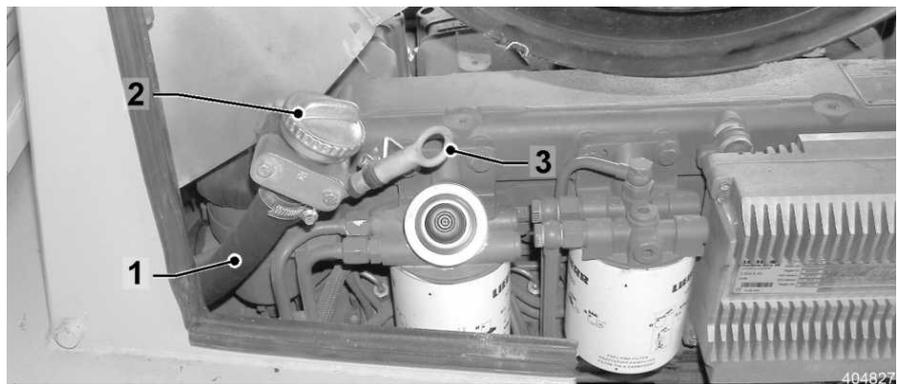
Fig. 390 Öleinfüllrohr, Ölmesstab
