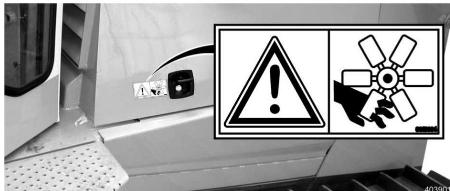
Fig. 302 Öffnen nur bei stillstehendem Motor
