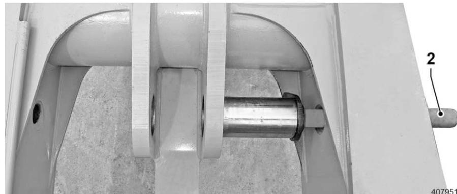
Fig. 223 Einschlagdorn für den Bolzen
