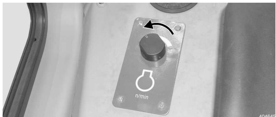
Fig. 183 Dieselmotor-Leerlaufdrehzahl
