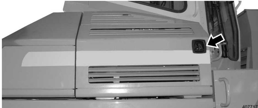
Fig. 420 Ölkühlerbehältertür
