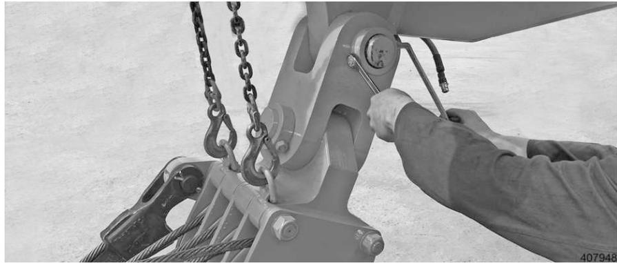
Fig. 220 Seilflasche montieren
