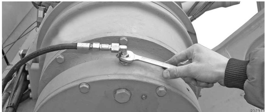
Fig. 204 Hydraulikleitung demontieren
