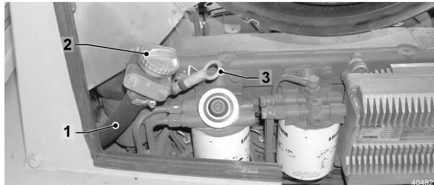
Fig. 388 Öleinfüllstutzen, Ölmessstab
