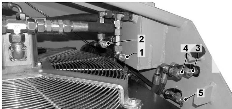
Fig. 421 Spül- und Füllanschlüsse
