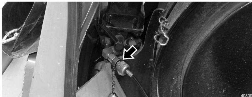
Fig. 201 Minimesseleitung anschließen
