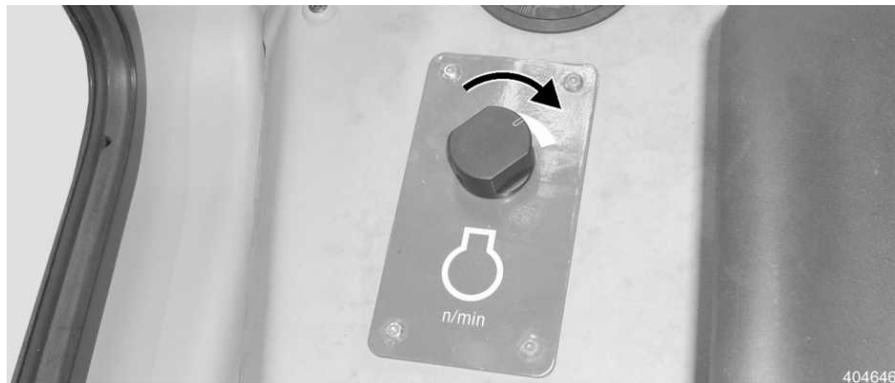
Fig. 166 Drehzahlregler für Volllast
