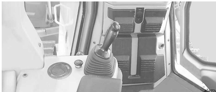
Fig. 177 Fahrhebel in Neutralstellung
