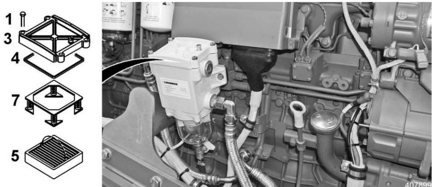
Fig. 357 Federkassette, Siebeinsatz
