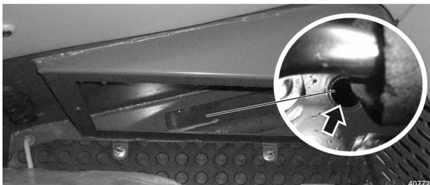
Fig. 409 Bohrung für den Wasserablauf
