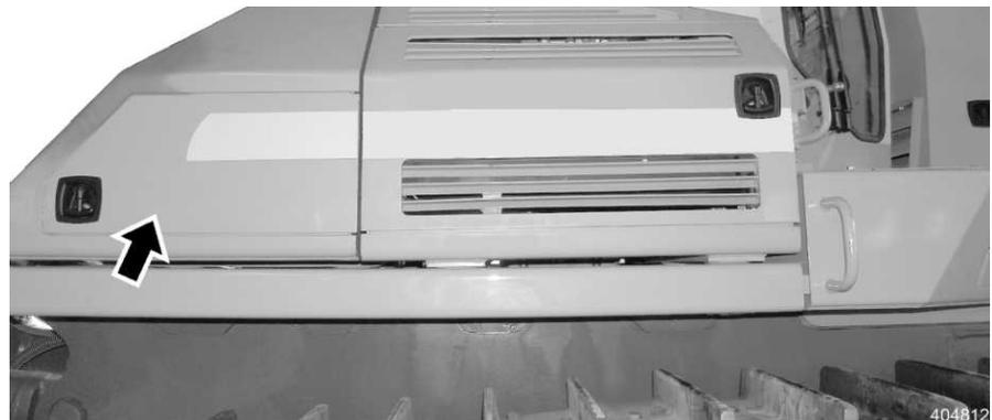
Fig. 392 Batteriebehälter
