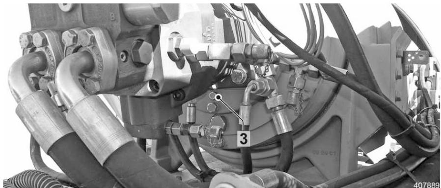
Fig. 462 Ölstandsschraube
