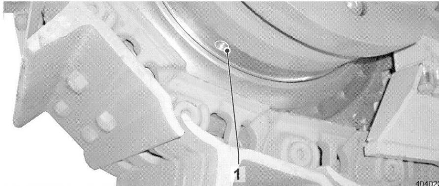
Fig. 426 Gleitringraum-Ablassschrauben
