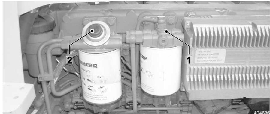
Fig. 350 Entlüftungsschraube am Filterkopf des Kraftstoff-Feinfilter
