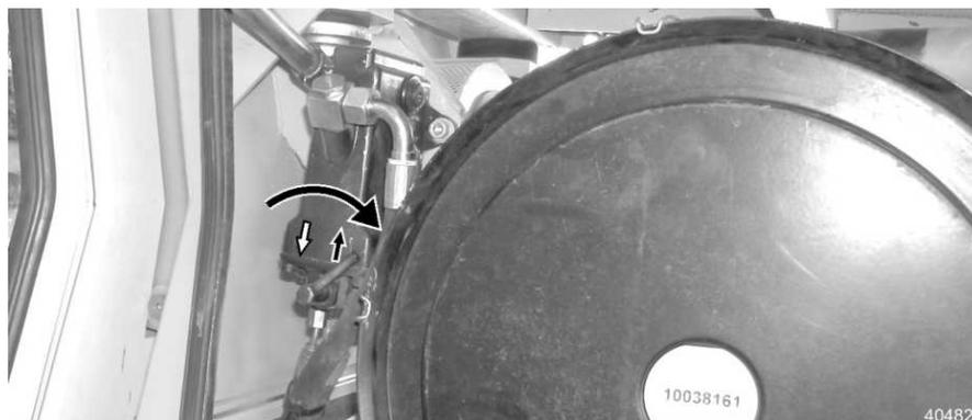
Fig. 482 Handpumpe auf Stellung „Heben“
