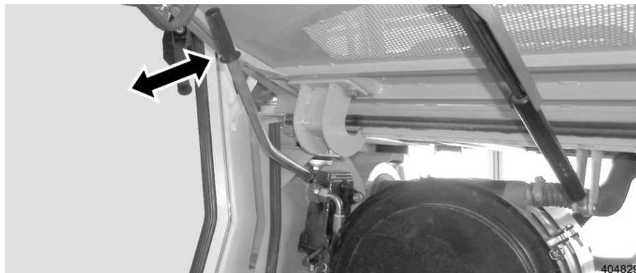
Fig. 207 Verlängerungsrohr einsetzen
