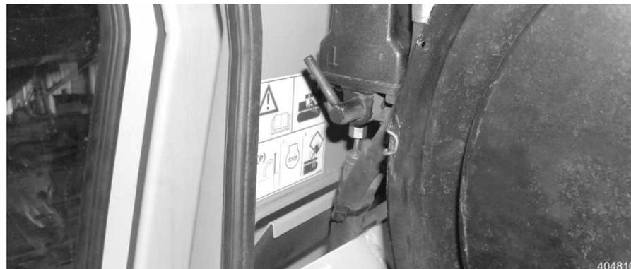
Fig. 24 Schild Fahrerstand-Kippeinrichtung
