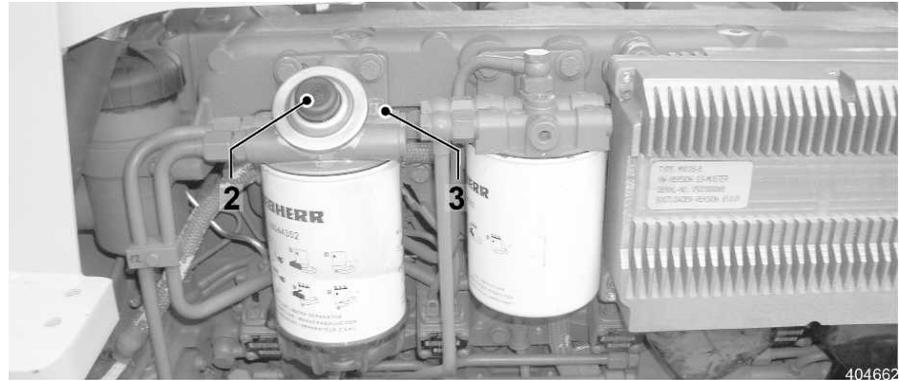
Fig. 349 Entlüftungsschraube am Filterkopf des Kraftstoff-Vorfilters
