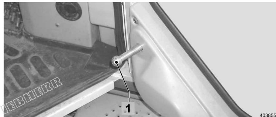
Fig. 105 Türfeststeller entriegeln
