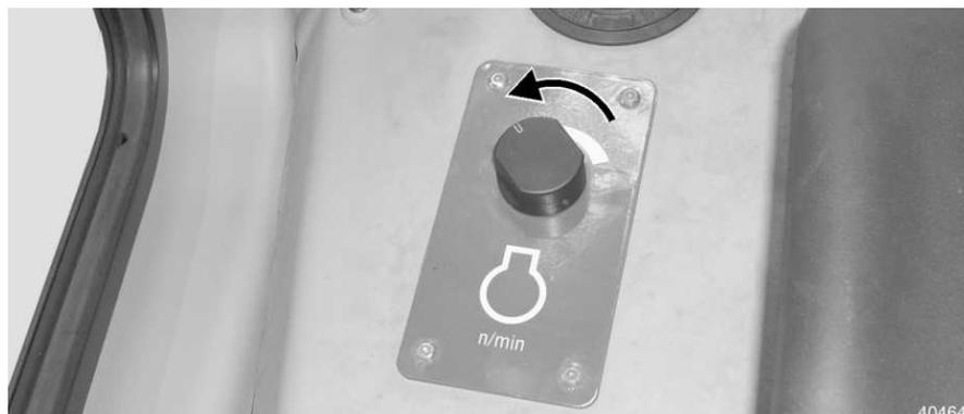
Fig. 158 Drehzahlregler für den Leerlauf
