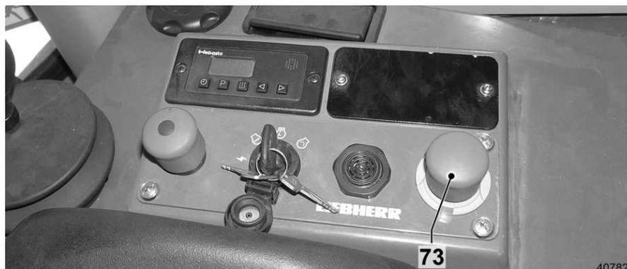
Fig. 97 Taster Überbrückung Überlastwarneinrichtung
