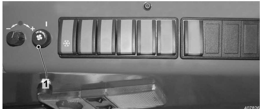
Fig. 125 Gebläsedrehschalter
