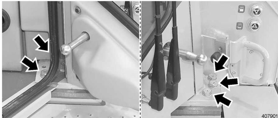
Fig. 490 Fahrerstand befestigen
