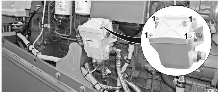
Fig. 356 Deckel demontieren
