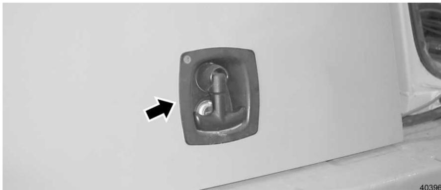
Fig. 303 Motorraumtür öffnen
