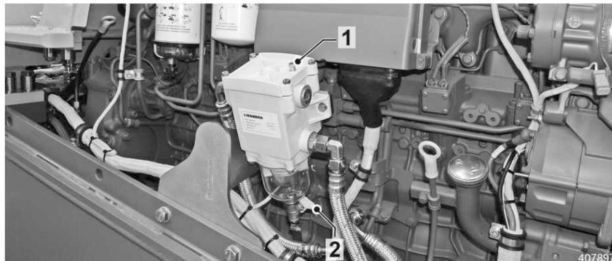
Fig. 355 Kraftstoffseparator
