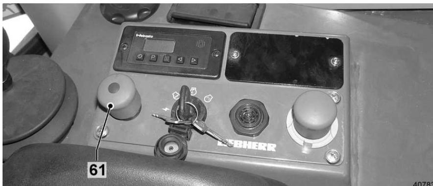
Fig. 249 Not-Aus-Taster angehoben
