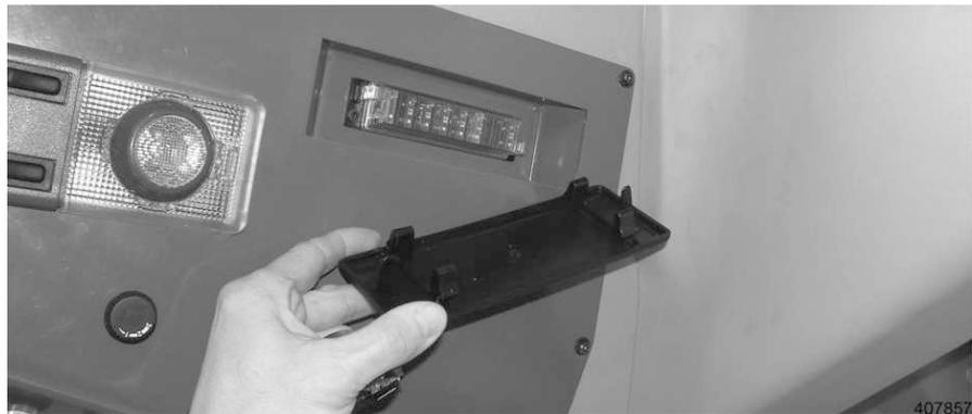
Fig. 264 Sicherungen in der Dachkonsole
