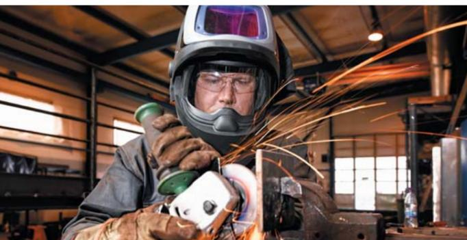
Eine funken- und spritzfeste Kopfabdeckung aus Textilgewebe ist Standardausstattung aller Speedglas 9100 FX Ausführungen. Optional ist eine verlängerte Kopfabdeckung und ein Ohren-/Halschutz als Zubehör erhältlich.
