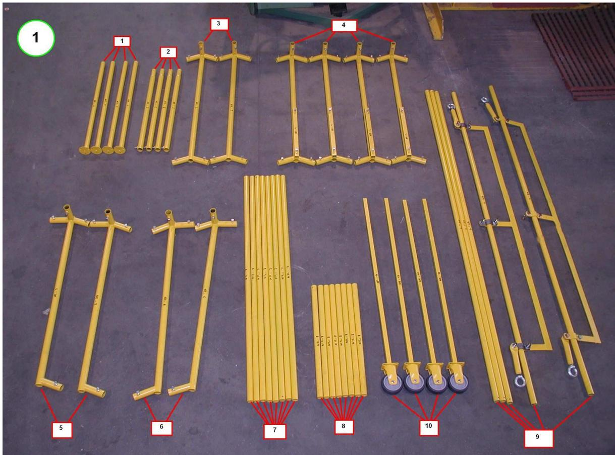
**Schritt 2: Rohrlaufrollen zusammenbauen. Teile Nr. 10 mit Teilen Nr. 4 verschrauben**
