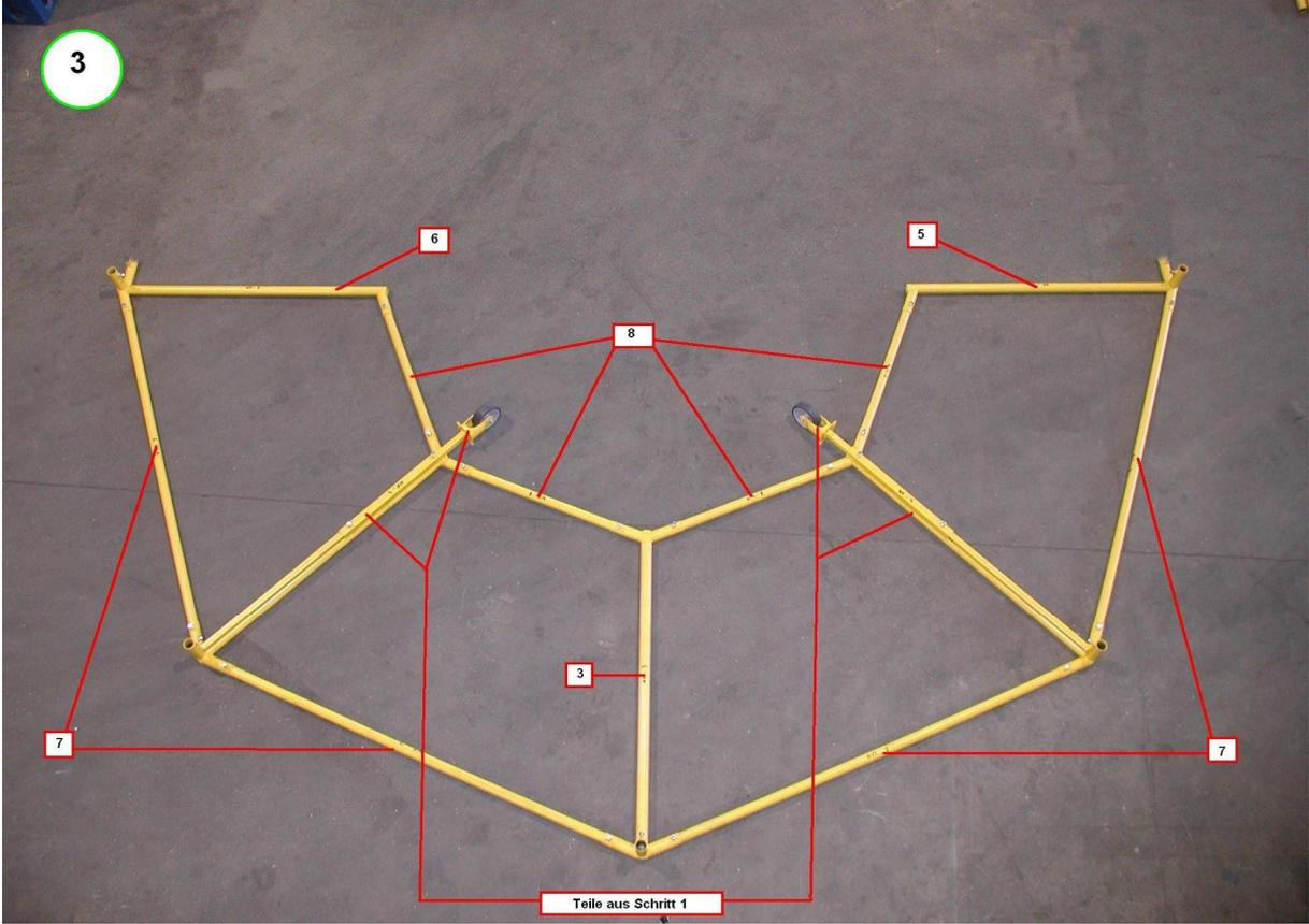
**Schritt 4: Front und Rückwand mit den Teilen Nr. 9 verbinden.**
