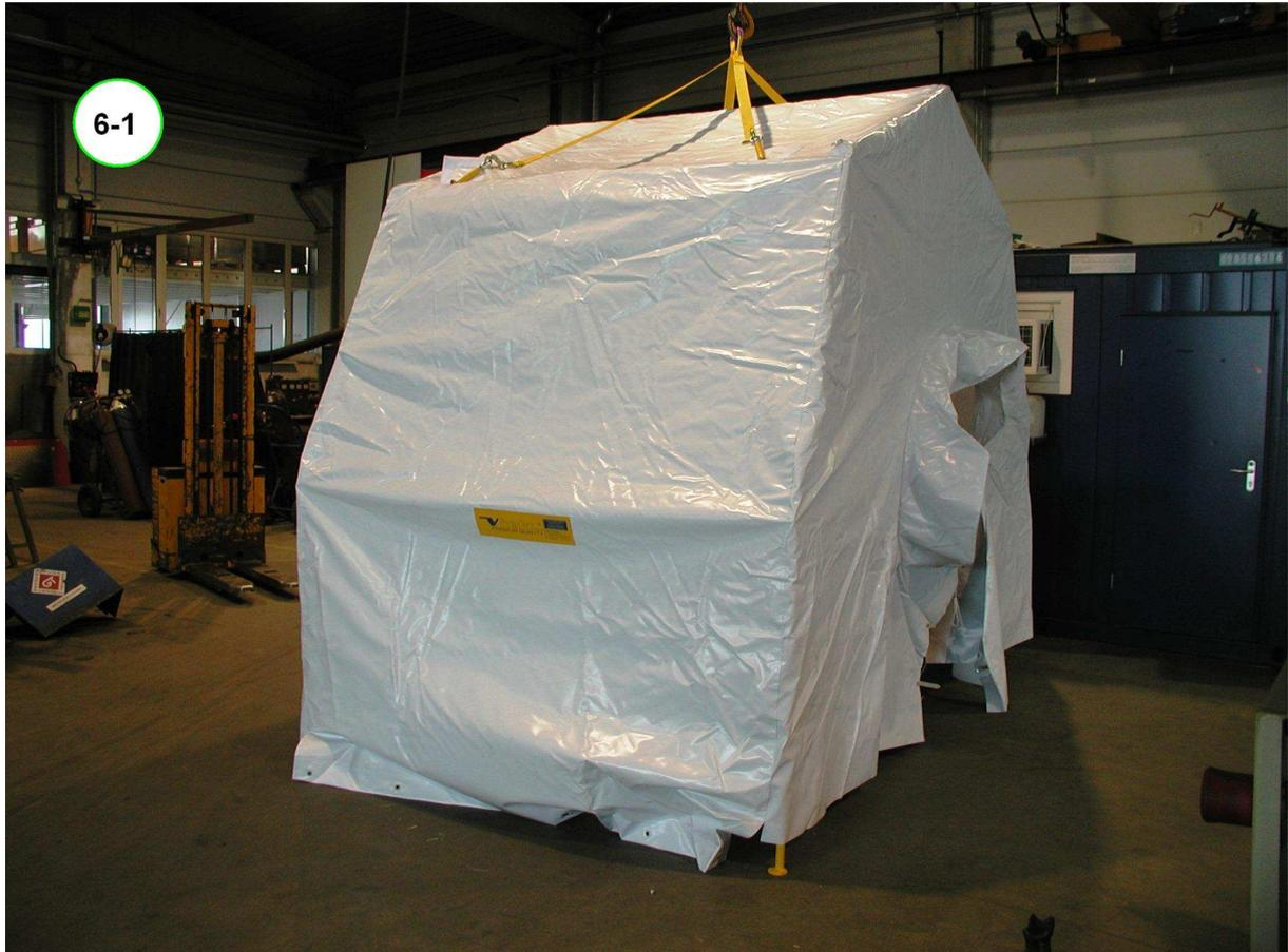
**Schritt 7: Zeltplane an Gestänge mittels der vorhandenen Bänder verzurren. Eventuell außen Mit Zeltschnur und Heringen verspannen. Laufrollen auf Rohr ausrichten.**
