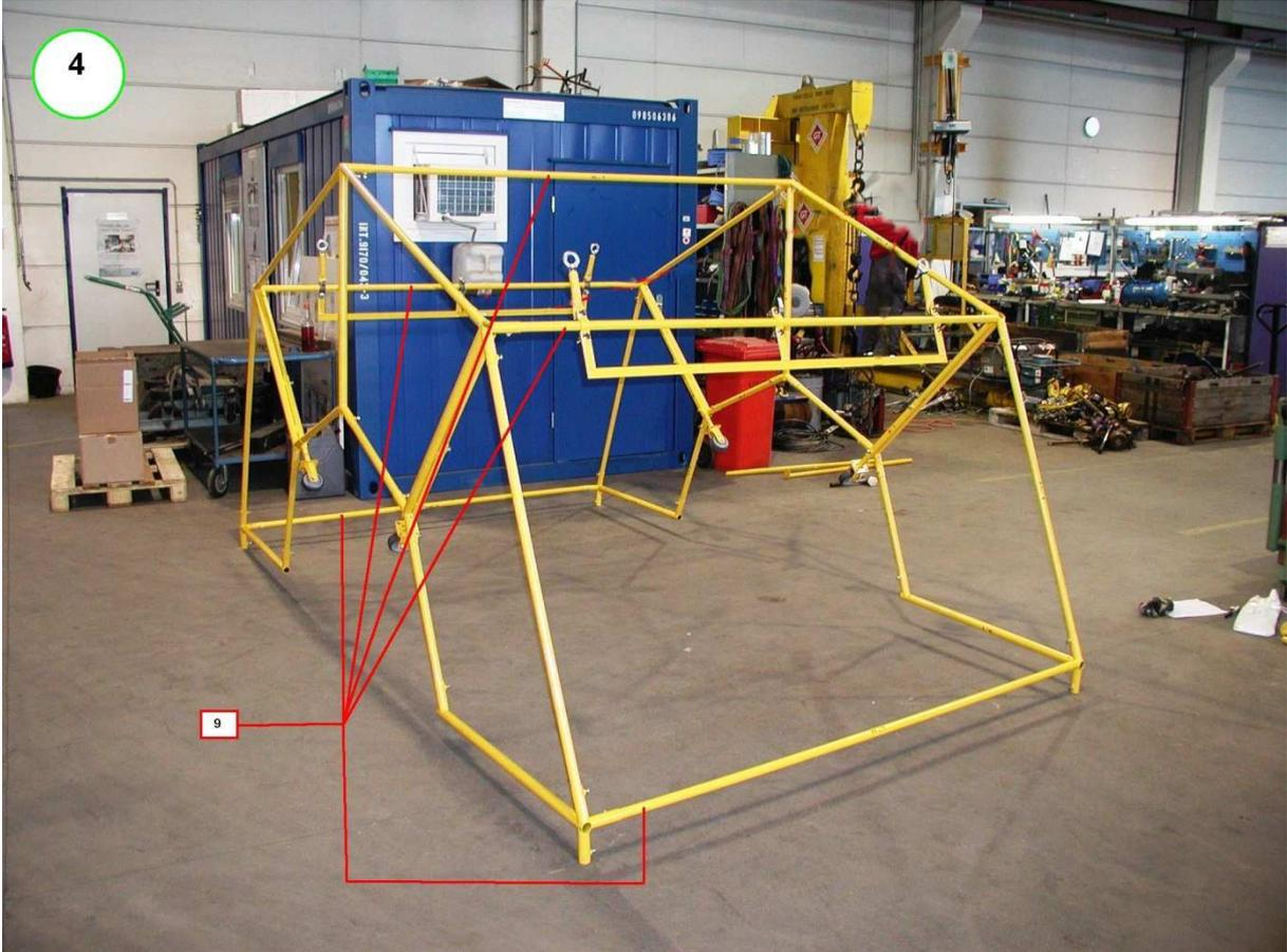
**Schritt 5: Zeltplane aufziehen. Kranösen in vorgesehene Löcher einfädeln. Hakengehänge an Kranösen befestigen.**
