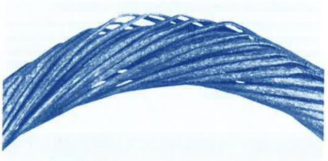
Bild 4 - Durch Abrostung und Abrieb stark gelockerte Litze
