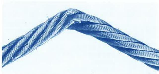
Bild 8 - Durch mechanische Einwirkung entstandener Knick
