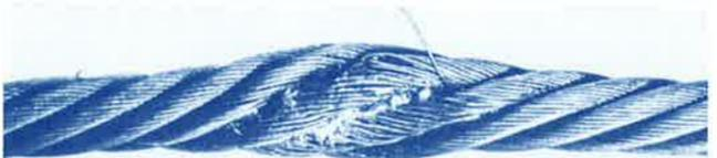
Bild 6 - Durch Überfahren abgeplattetes Drahtseil
