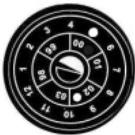
Mit der Prüfplakette am Gerät wird die letzte Wartung bestätigt und der nächste Termin gekennzeichnet (z.B. 5/02 = Mai 2002).
