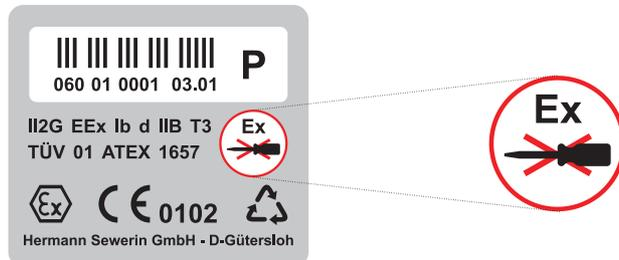
Auf dem Typenschild-Aufkleber (Geräterückseite) finden Sie ein Piktogramm, welches einen durchgestrichenen Schraubendreher darstellt. Dieses bedeutet, dass das Öffnen des Batteriefaches nur außerhalb des explosionsgefährdeten Bereiches erfolgen darf !
