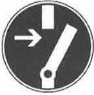
**Nehmen Sie die Maschine außer Betrieb und sichern Sie die Spannungsquelle gegen unbeabsichtigtes Wiedereinschalten.**
