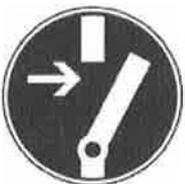
**Bei Wartungs- und Reparaturarbeiten, sowie beim Einrichten der Maschine, den Hauptschalter ausschalten und gegen Wiedereinschalten sichern!**
