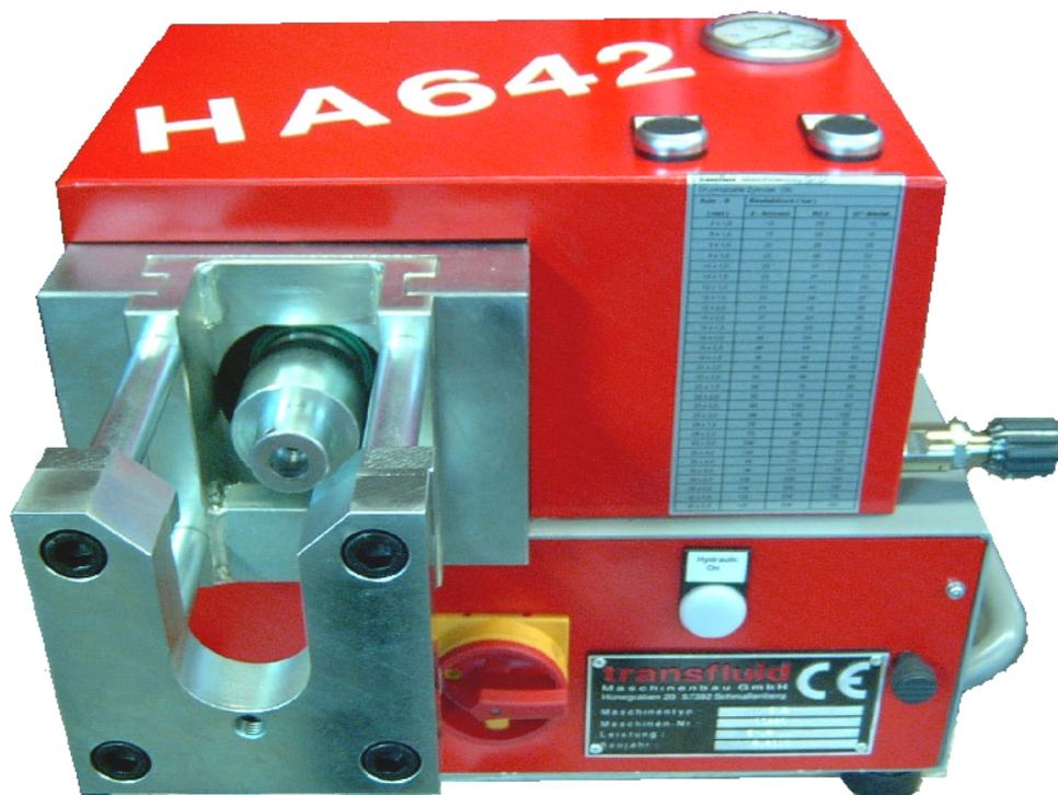
HA 642 Antriebseinheit (mit Vorsatzgerät Schneidringvormontage)
