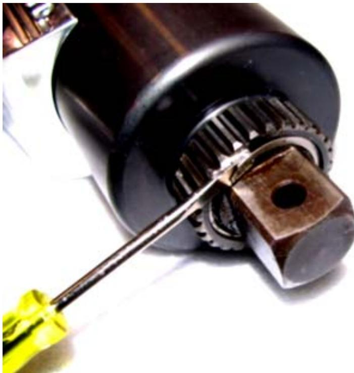
*Abb. 20: Entfernen des Sicherungsrings für den Vierkant*
