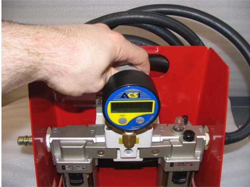
Abb. 24: Einstellen des Druckreglers der Wartungs- und Einstelleinheit
