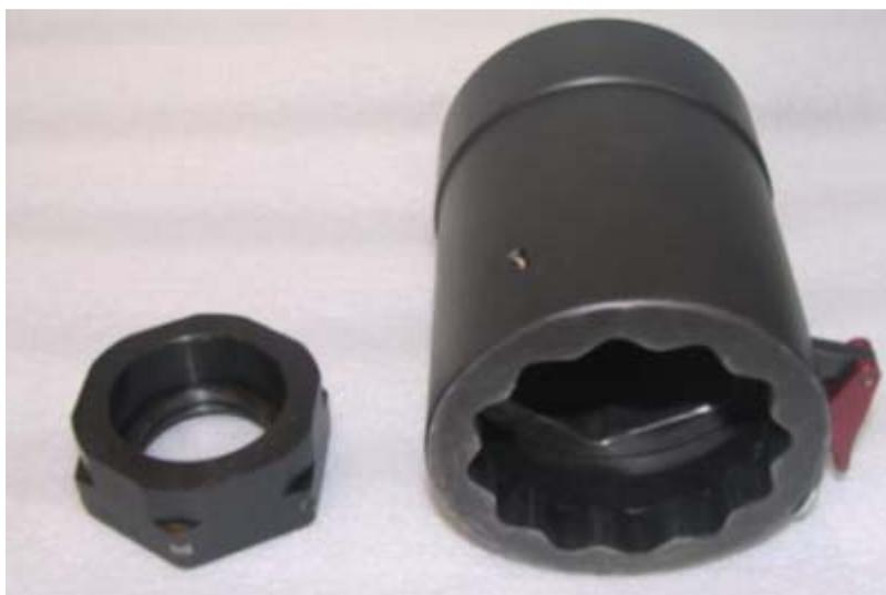
*Abb. 27: Loadisc-Scheibe und Antrieb*
