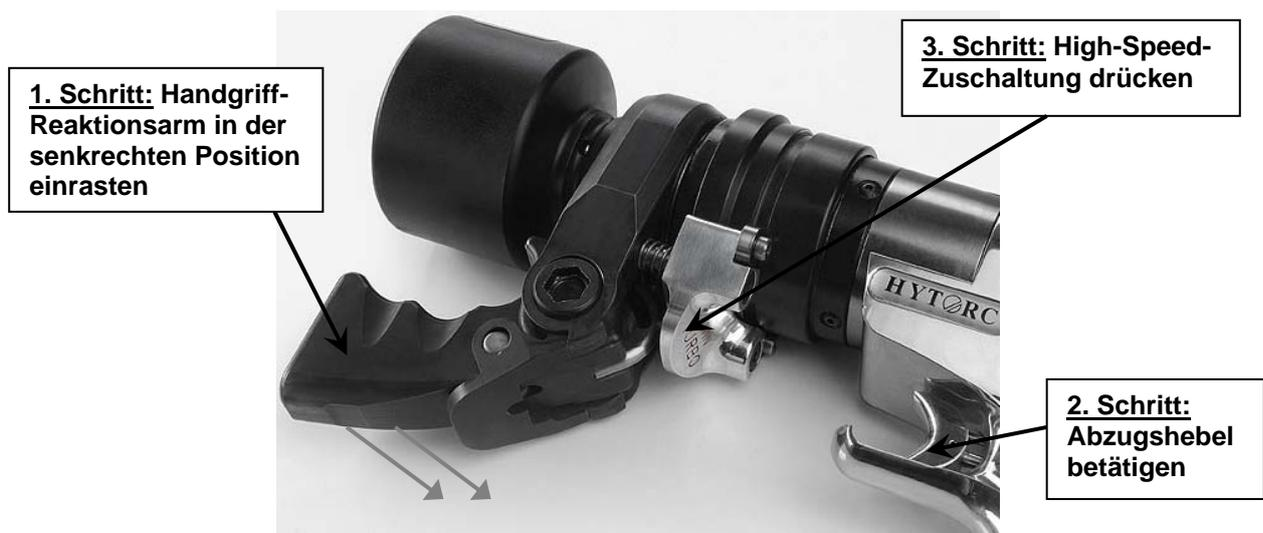
Abb. 17: Wechsel vom High-Speed- in den Drehmomentmodus
