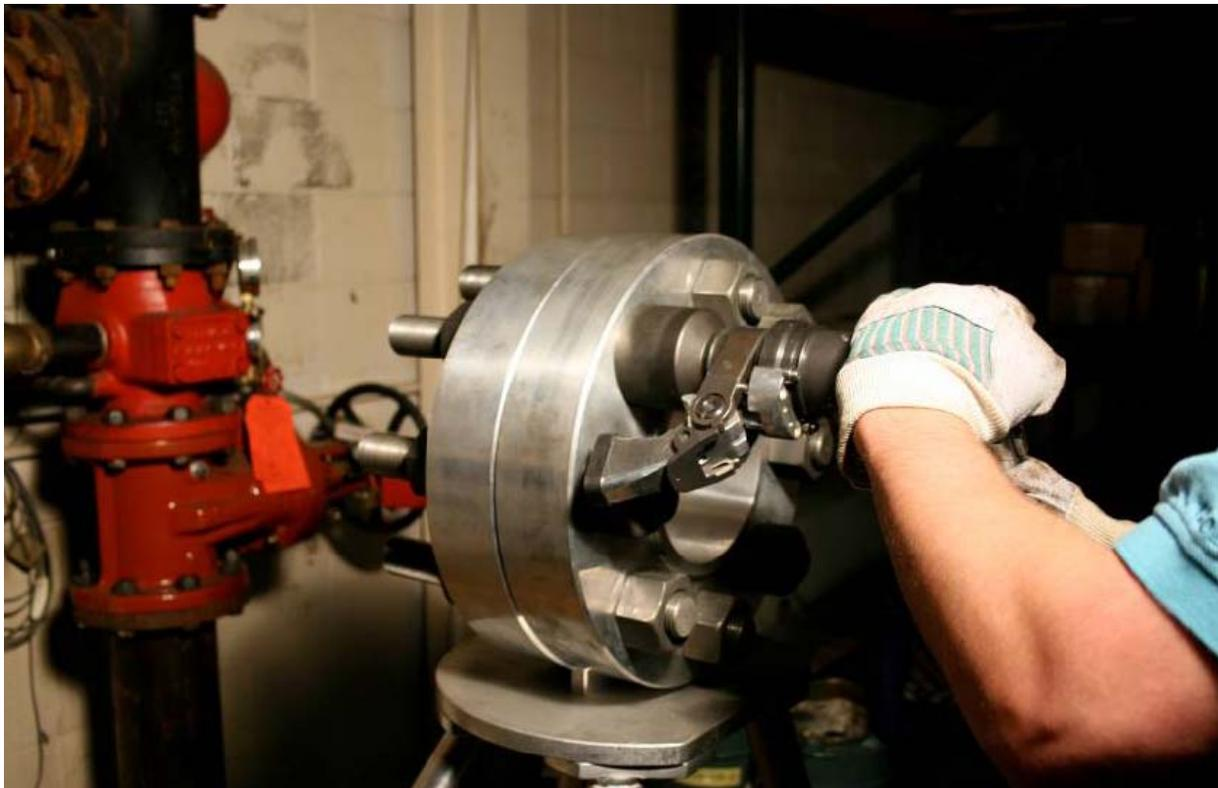
*Abb. 19: Anziehen im Drehmomentmodus*
