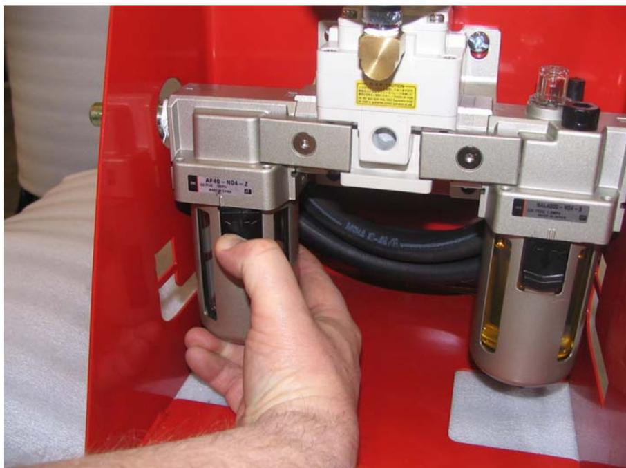
Abb. 22: Leeren des Filter-Wasserabscheider-Reservoirs
