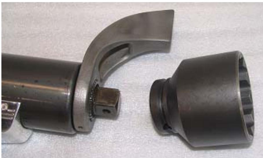
Abb. 6: Montage einer Nuss auf der jGun
