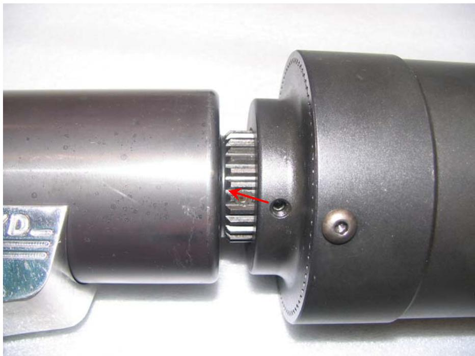
Abb. 30: Korrektes Aufsetzen des LoadDisc-Antriebes
