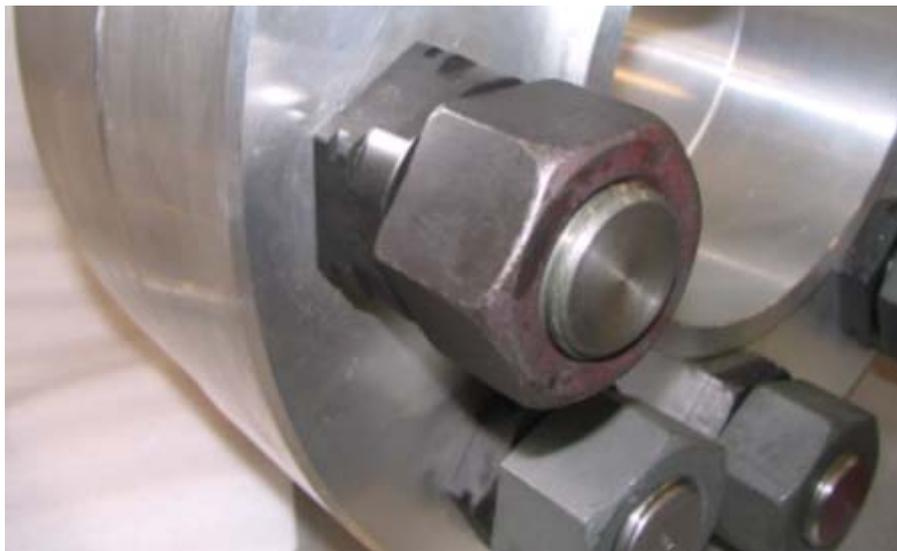
*Abb. 29: LoadDisc-Scheibe montiert*
