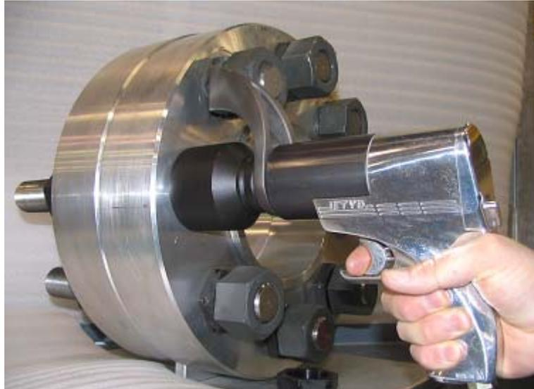
*Abb. 11: jGun im Einsatz (beim Lösen)*
