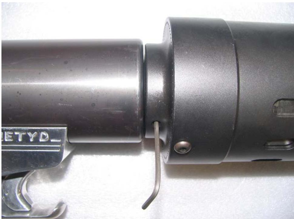
Abb. 31: Festziehen der Mutterschraube des LoaDisc-Antriebs
