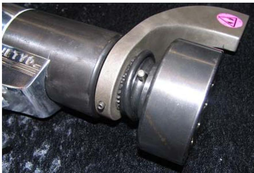
Abb. 7: Einsetzen des Sicherungsstiftes sowie des Halterings
