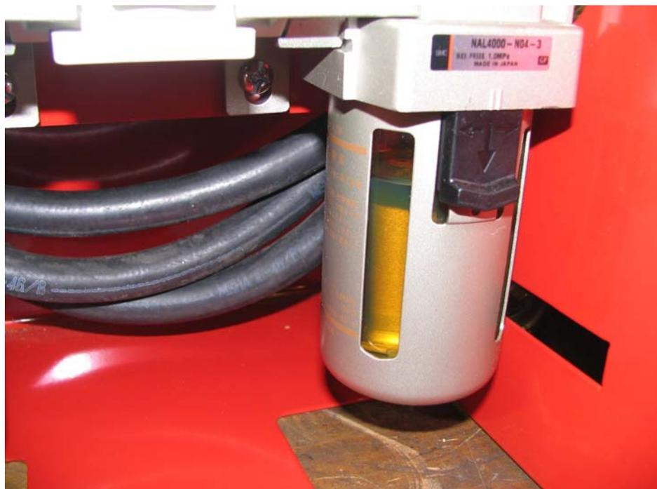
Abb. 25: Wartungseinheit – Öler zu 2/3 befüllt
