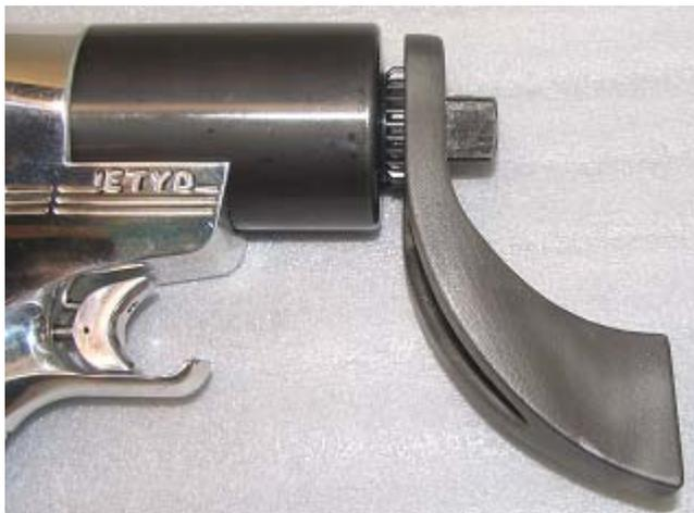
*Abb. 4: Reaktionsarm montiert*
