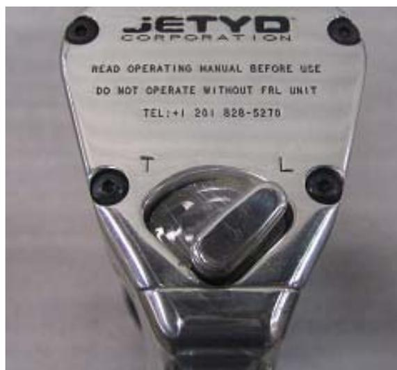
Abb. 9: Richtungsschalthebel
