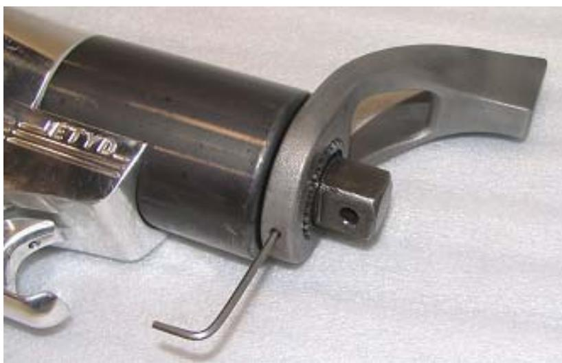
*Abb. 5: Festziehen der Halteschraube am Reaktionsarm*
