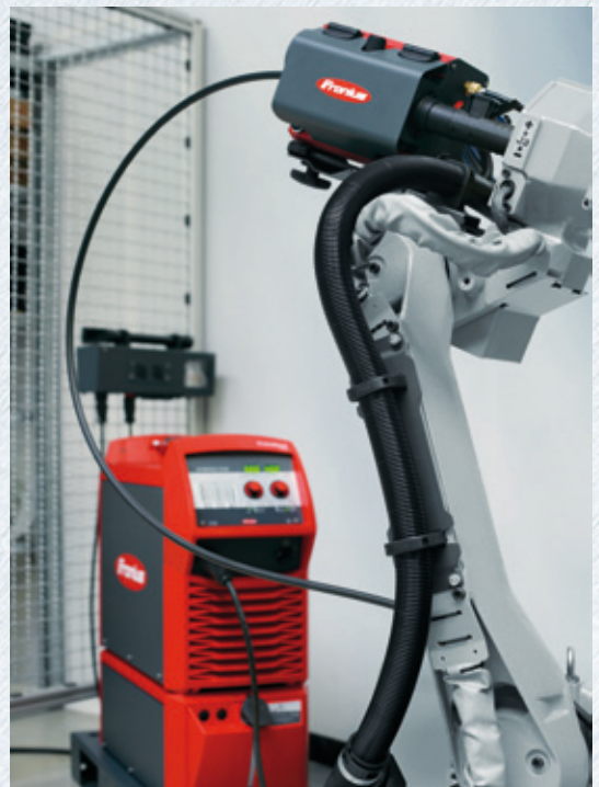
TransSteel Robotics Systemaufbau.
