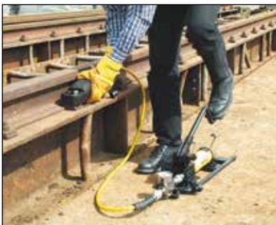
◀ Das einfache Entfernen rostiger Muttern bei Eisenbahnarbeiten ist nur eines der vielen Anwendungsbeispiele des Enerpac Mutternsprengers.
